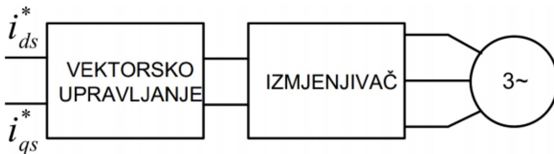
**Slika 3.10.** Shema vektorskog upravljanja asinkronog motora [13]
