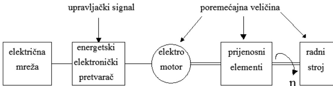
**Slika 3.1.** Elektromotorni pogon s otvorenom vezom
