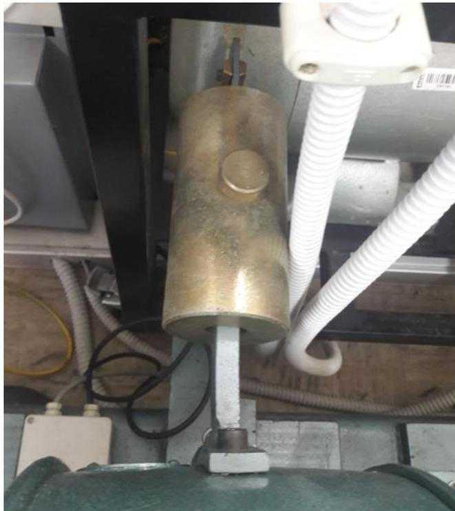
**Slika 4.11.** Senzor momenta motora
