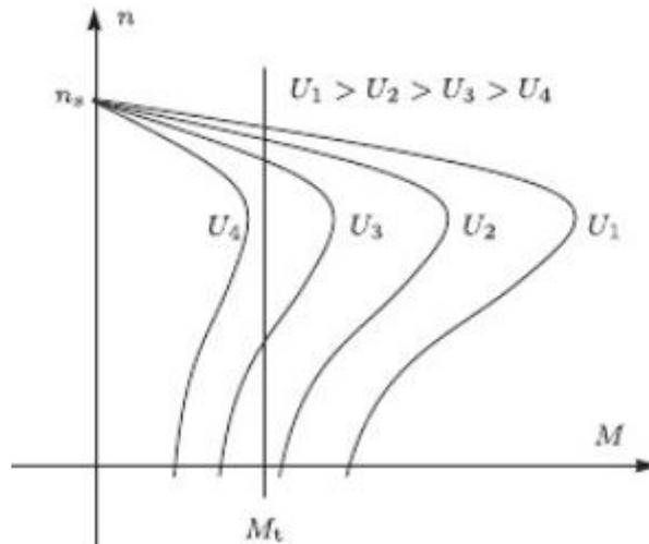
**Slika 3.4.** Mehaničke karakteristike motora s promjenjivim naponom napajanja [6]
