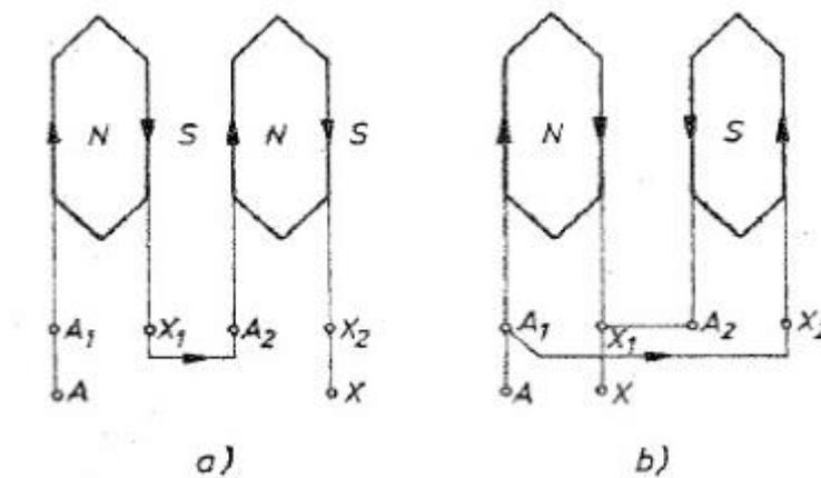
**Slika 3.5.** Shema prespajanja jednog namotaja statora [10]
