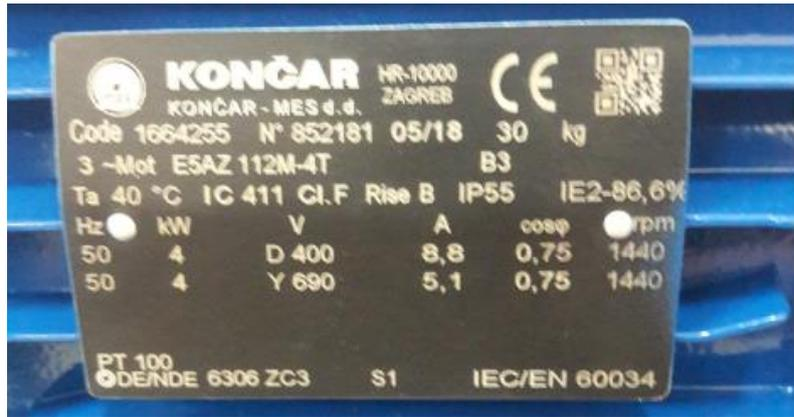
Slika 4.6. Natpisna pločica asinkronog motora
