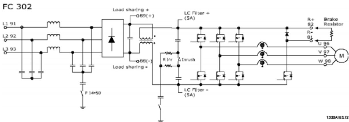
Slika 3.14. Shematski prikaz energetskeg dijela pretvarača [14]
