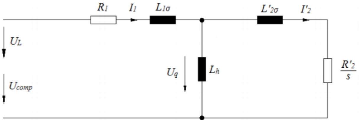
Slika 3.17 Nadomjesna shema trofaznog izmjeničnog motora pod opterećenjem [9]
