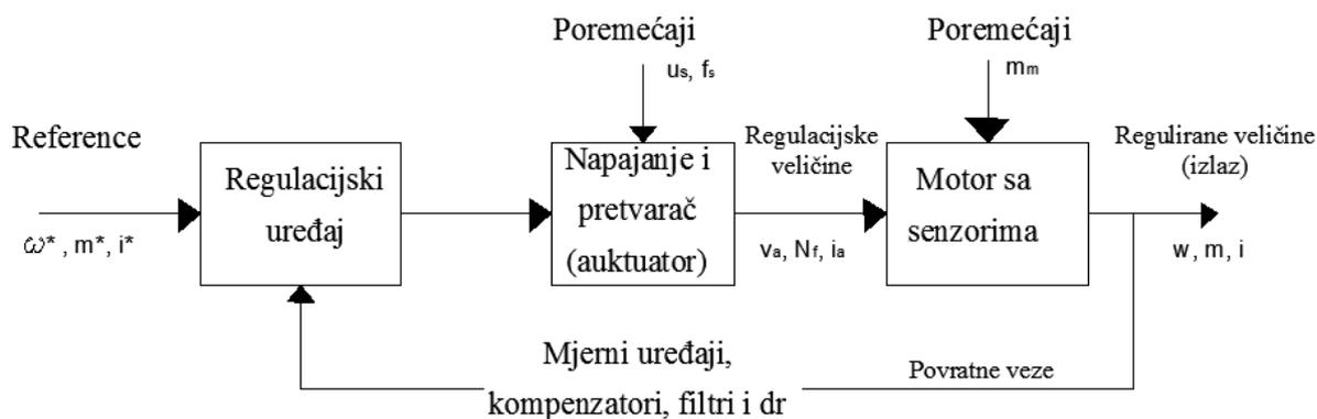
**Slika 3.2** Elektromotorni pogon s automatskom regulacijom
