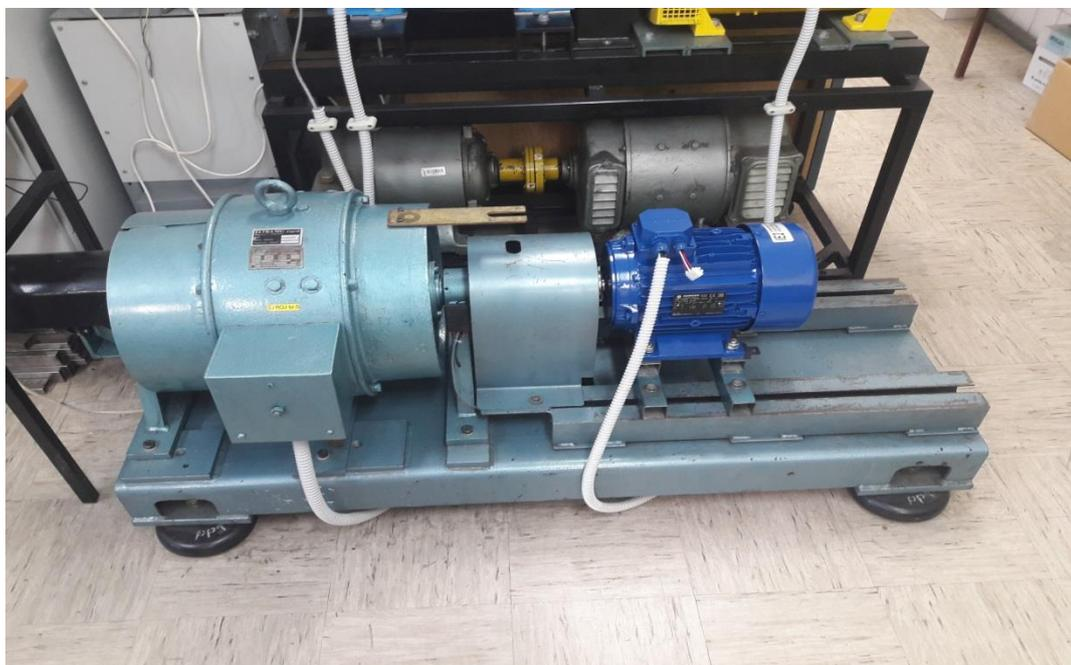
Slika 4.5. Ispitivani asinkroni stroj (desno) terećen istosmjernim generatorom (lijevo)
