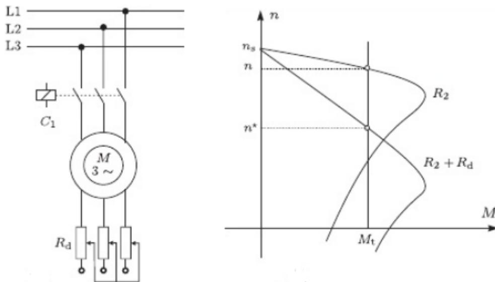
**Slika 3.3.** Shema spoja i mehanička karakteristika asinkronog motora za upravljanje brzine vrtnje promjenom otpora rotora.[6]
