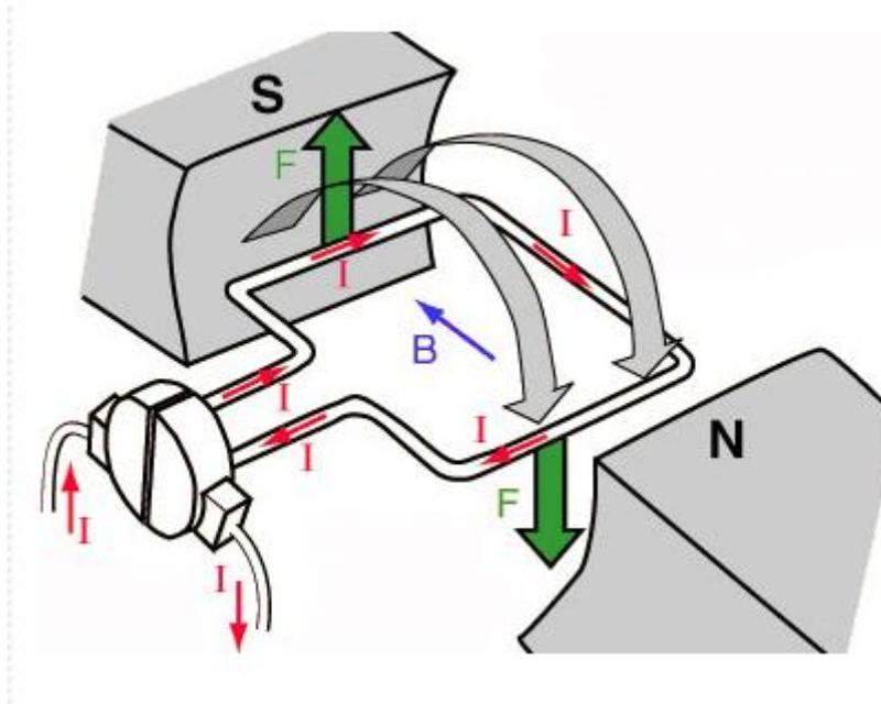
**Slika 2.2.** Princip rada elektromotora [5]
