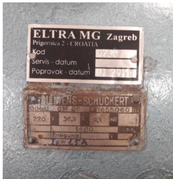
Slika 4.7. Natpisna pločica istosmjernog generatora
