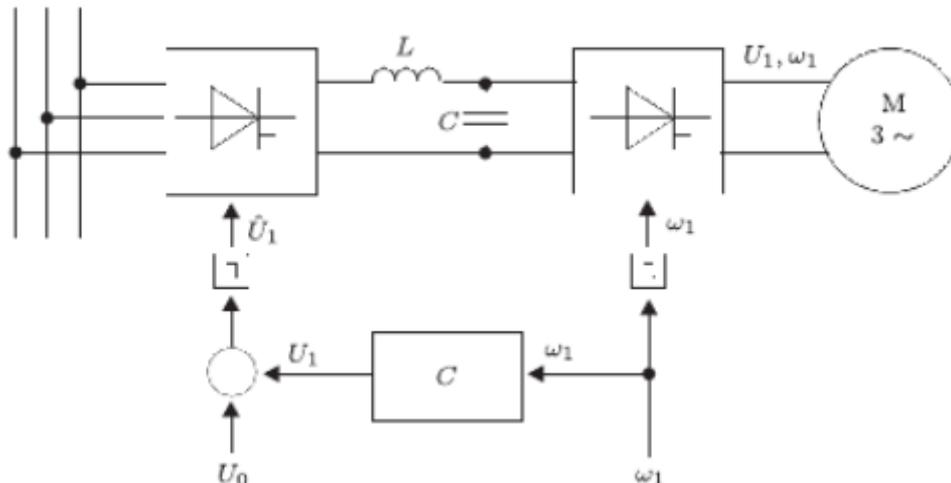
**Slika 3.9.** Osnovna shema skalarnog upravljanja asinkronim motorom [6]
