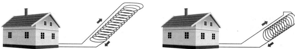
*Slika 3.9. Spiralni kolektor 'Slinky'(lijevo) i 'Svec' (desno) [7]*
