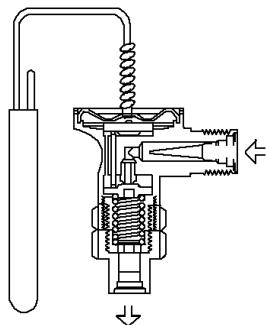
Slika 4.6. Grafički prikaz ekspanzijskog ventila [12]
