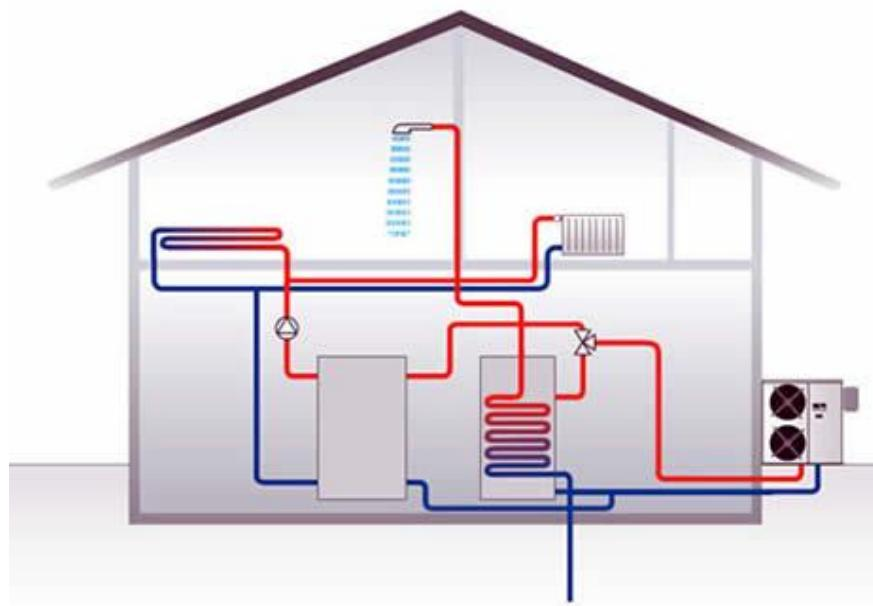
*Slika 3.1. Sustav grijanja toplinske crpke zrak/voda [5]*
