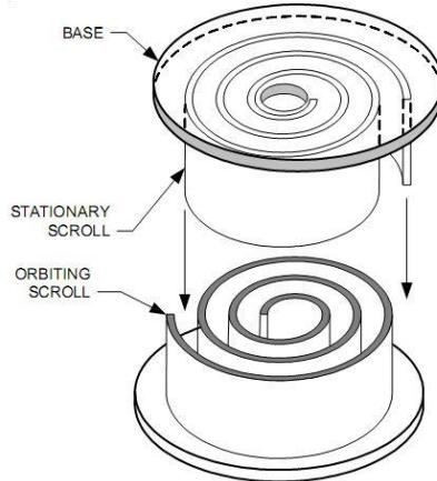
Slika 4.2. Svitak spiralnog kompresora[9]
