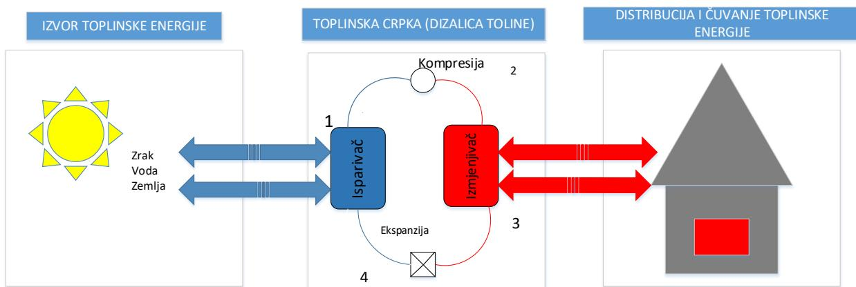
Slika 2. 1. Princip rada toplinske crpke
