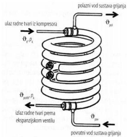
*Slika 4.4. Kondenzator s dvostrukom koaksijalnom cijevi[7]*
