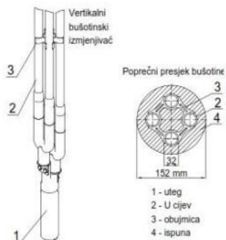
Slika 3.6. Prikaz dvostrukе U cijevi i poprečni presjek bušotine[7]
