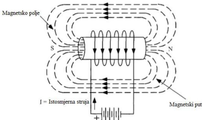
Slika 3.4. Zavojnica sa zračnom jezgrom sa istosmjernom uzbudom[5]
