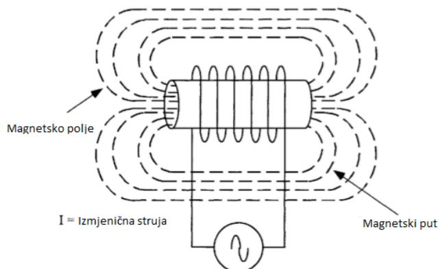
Slika 3.6. Zavojnica sa zračnom jezgrom sa izmjeničnom uzbudom[5]
