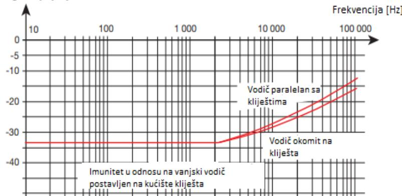
Slika 2.5. Amplitudno-frekvencijska karakteristika[3]
