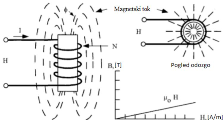
Slika 3.9. Emitiranje magnetskog toka uzuđene zavojnice sa zračnom jezgrom[5]
