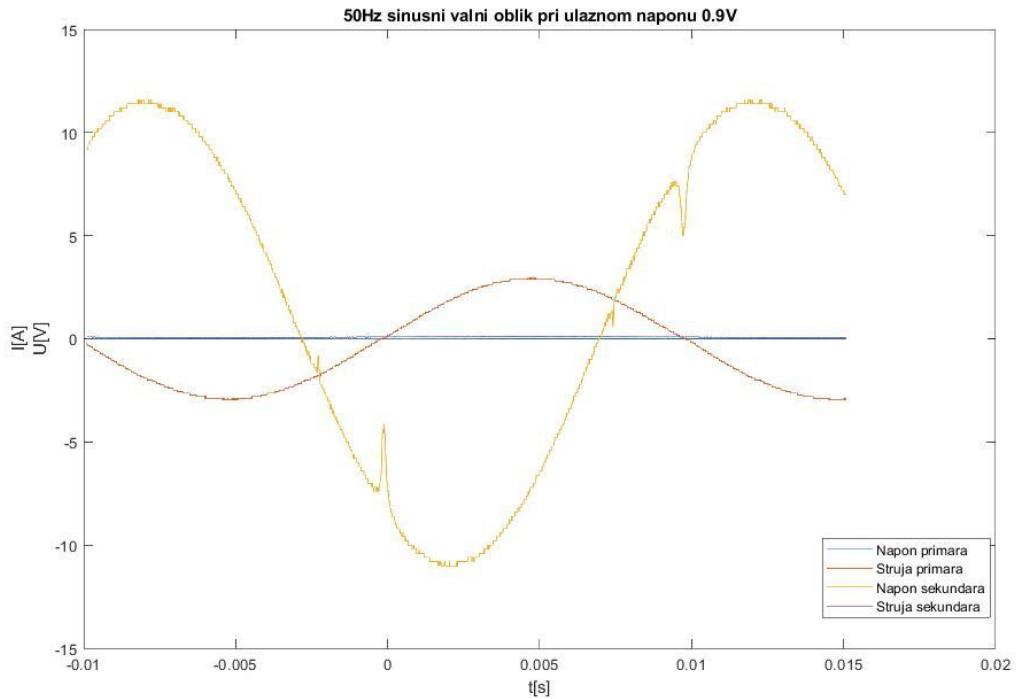
*Slika 4.25. Valni oblici struje i napona primara i sekundara za sinusni valni oblik uz frekvenciju 50Hz pri ulaznom naponu 0.9V*
