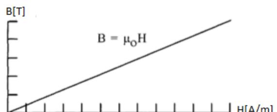
Slika 3.5. Odnos  $B$  i  $H$  sa istosmjernom uzbudom[5]
