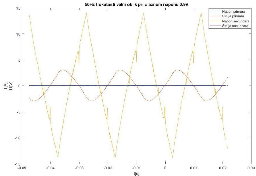
*Slika 4.31. Valni oblici struje i napona primara i sekundara za trokutasti valni oblik uz frekvenciju 50Hz pri ulaznom naponu 0.9V*
