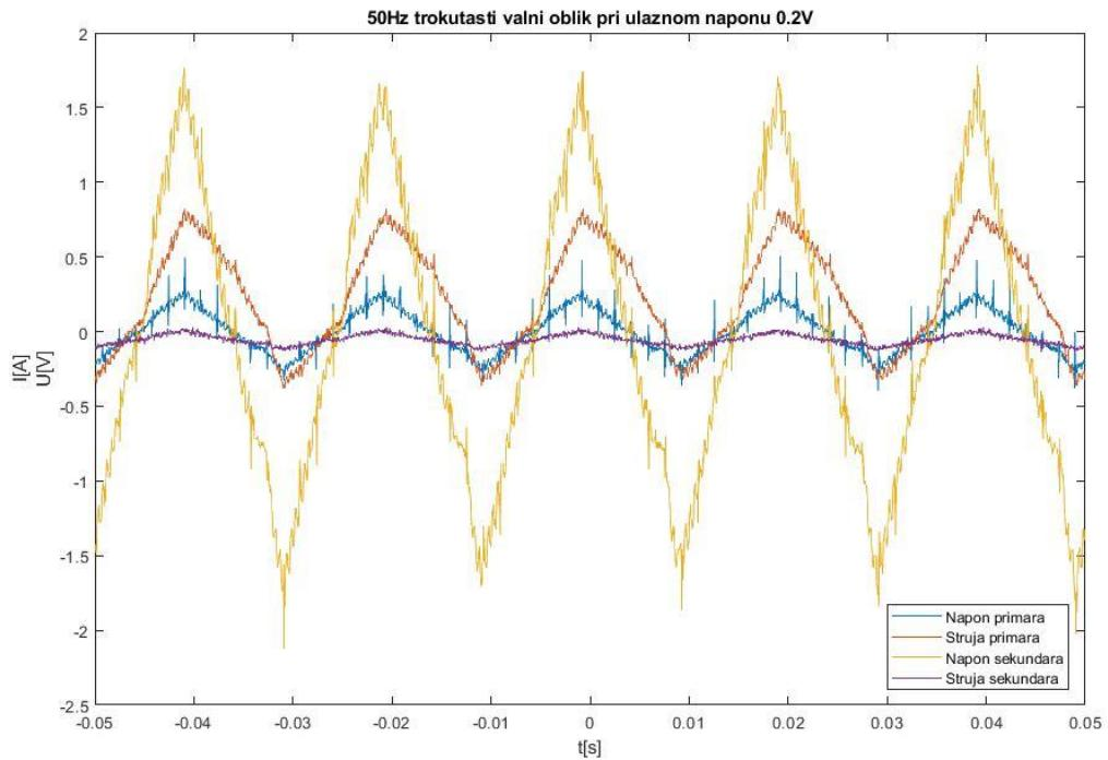
*Slika 4.11. Valni oblici struje i napona primara i sekundara za trokutasti valni oblik uz frekvenciju 50Hz pri ulaznom naponu 0.2V*
