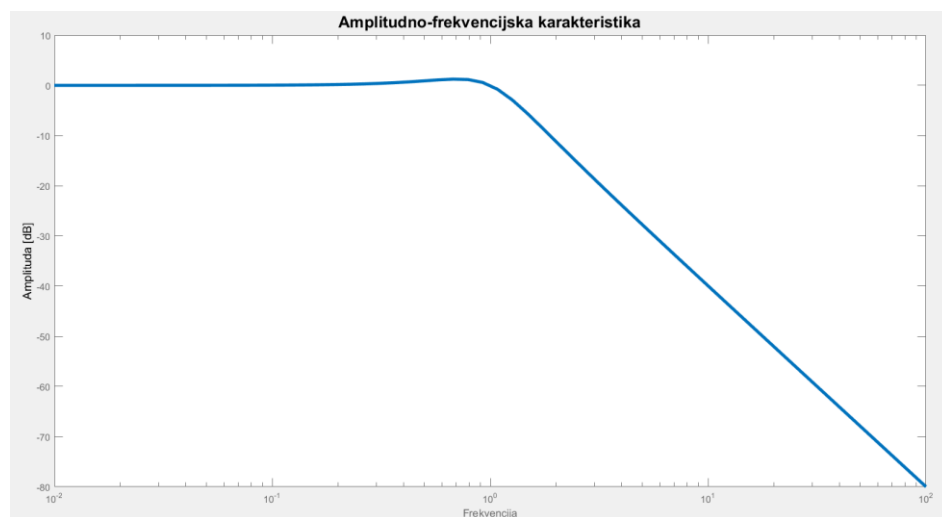
Slika 2.6 Amplitudno-frekvencijska karakteristika s logaritamskom osi sustava sa slike
