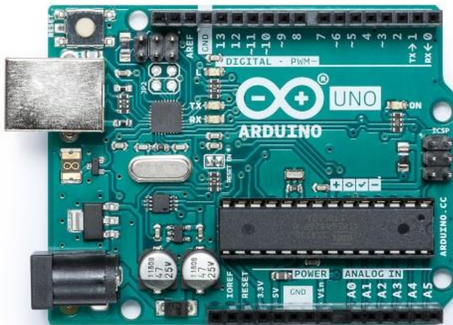
Sl. 2.2. Arduino Uno, Izvor: store.arduino.cc
