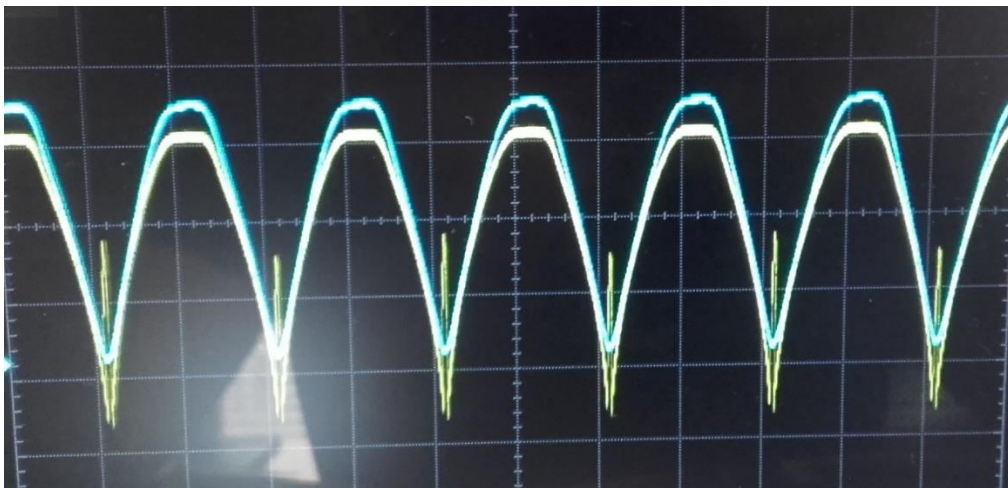
Slika 3.11 Valni oblik za napon 15 V i struju 4 A
