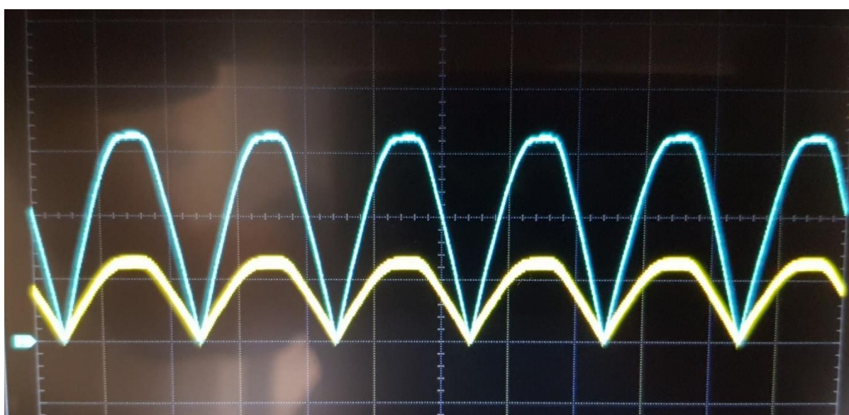
Slika 3.9 Valni oblik napona i struje na trošilu pri strujama manjim od 1 A
