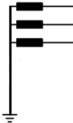
Slika 2.1. Pogonsko uzemljenje zvjezdišta transformatora [1]
