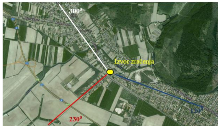
Sl. 3.9. Geometrijski plan pozicije izvora zračenja sa označenim glavnim smjerovima zračenja (maksimuma zračenja) [1]
