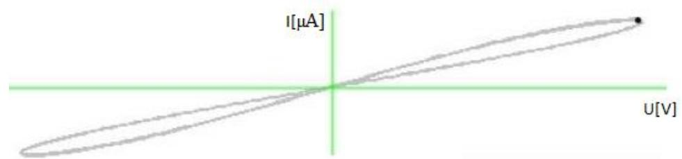
**Slika 4.5.** Strujno naponska karakteristika naponski upravljanog memristora pri frekvenciji iznosa  $10\text{Hz}$
