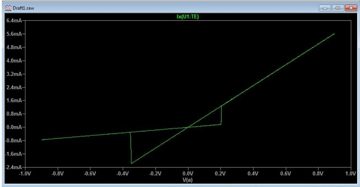
4.10. Strujno-naponska karakteristika Pino memristora pri frekvenciji od 5Hz
