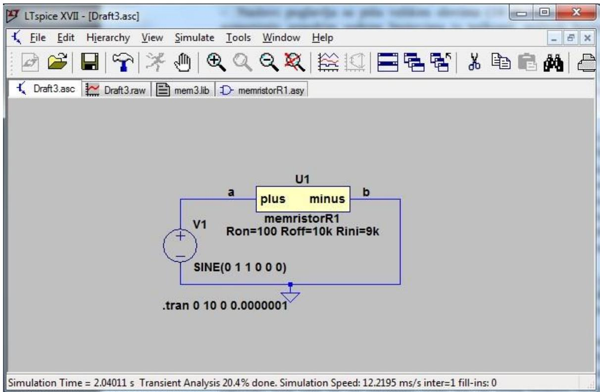
**4.16.** Shematski prikaz strujnog kruga s Biokom memristorom
