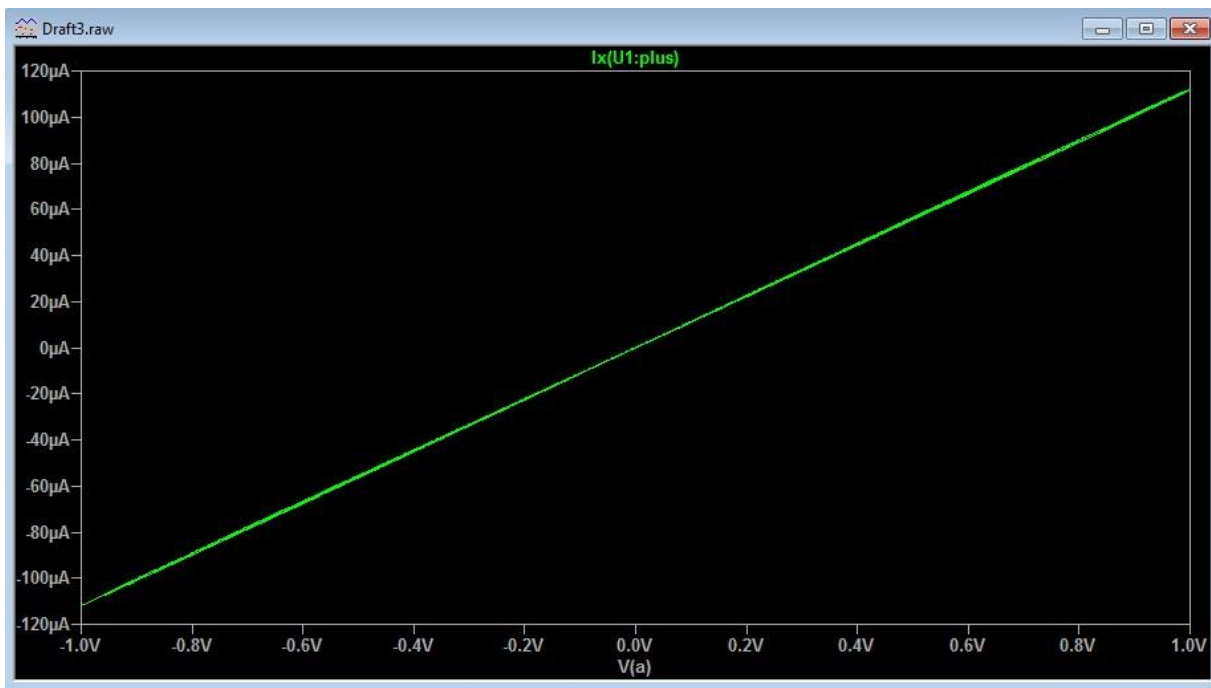
4.17. Strujno-naponske karakteristike Biolek memristora 10Hz
