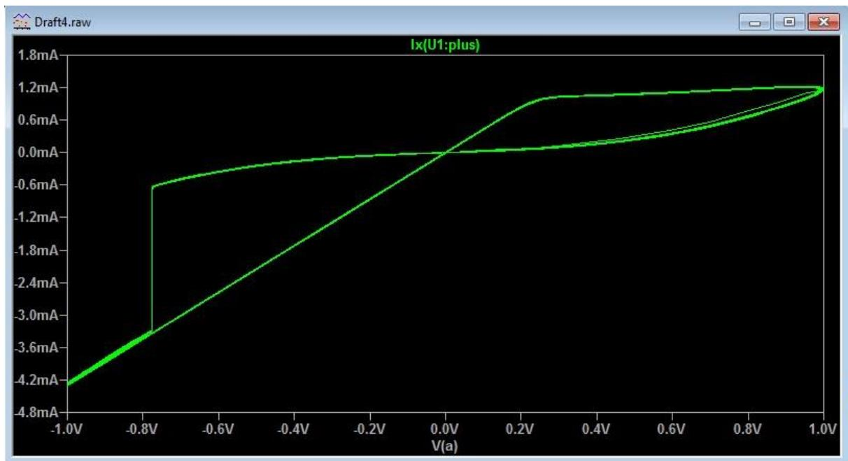
4.23. Strujno-naponska karakteristika  $TiO_2$  memristora pri frekvenciji od  $1000Hz$
