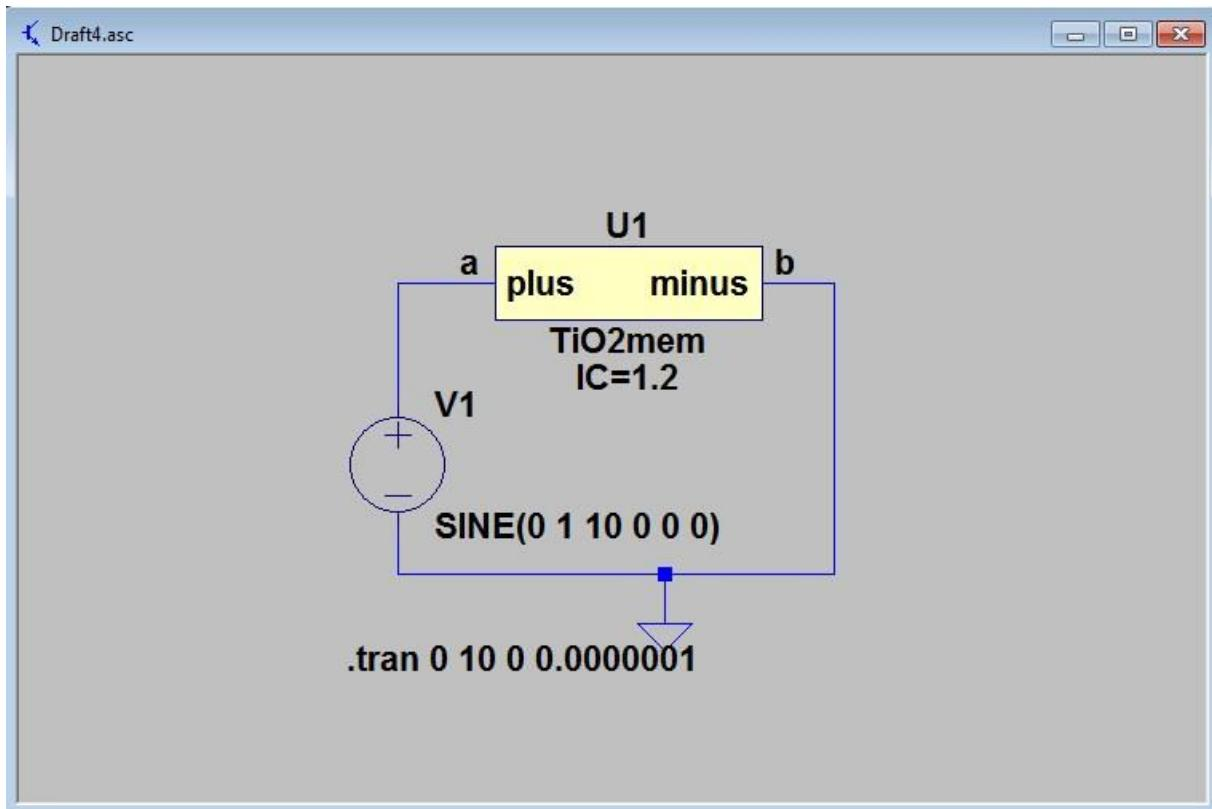
**4.20.** Shematski prikaz strujnog kruga s TiO<sub>2</sub> memristorom
