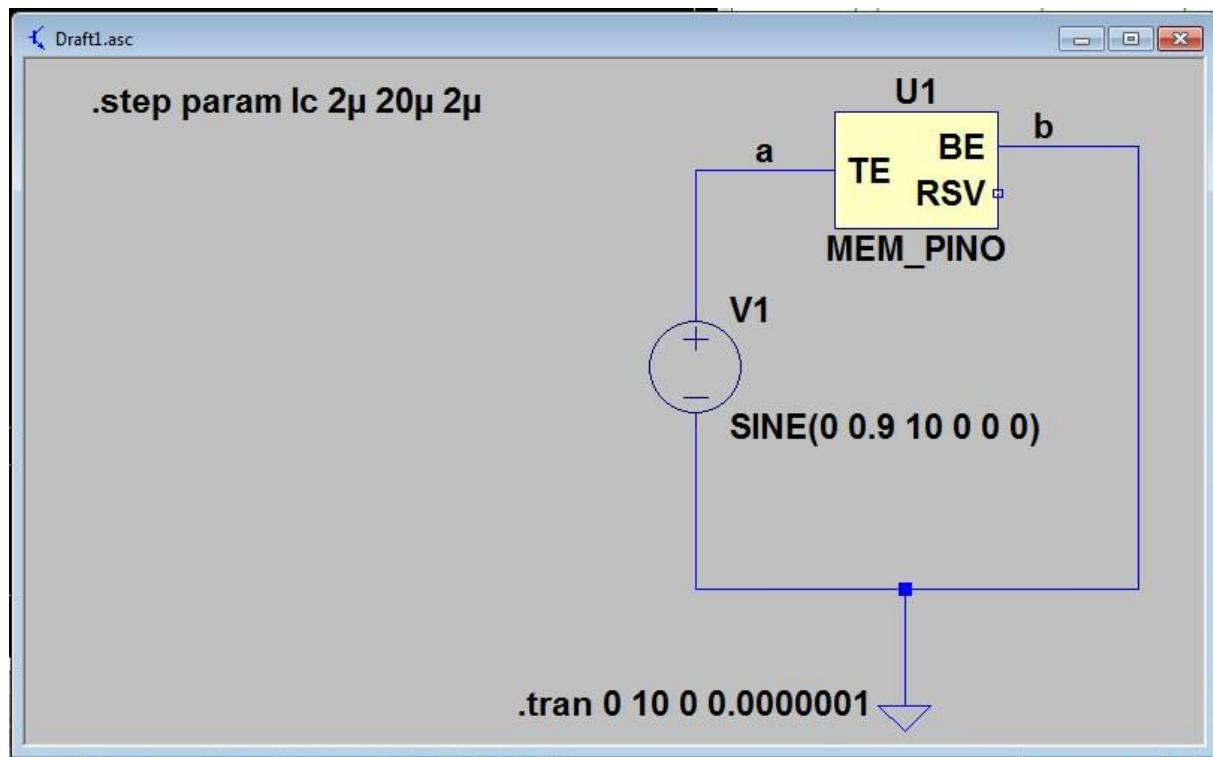
**4.8. Shematski prikaz strujnog kruga s Pino memristorom**
