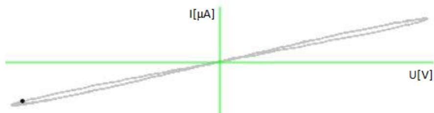
**Slika 4.6.** Strujno naponska karakteristika naponski upravljanog memristora pri frekvenciji iznosa  $20\text{ Hz}$
