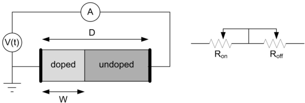
**Slika 2.2.** Struktura memristora donešena od strane HP istražitelja te njezina pripadajuća shema [2]
