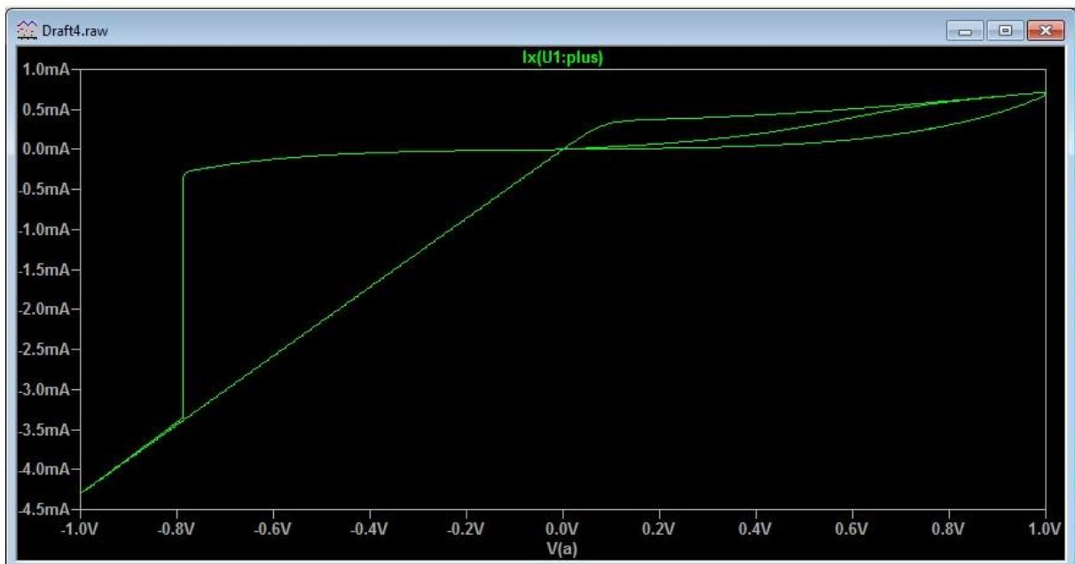
4.22. Strujno-naponska karakteristika  $\text{TiO}_2$  memristora pri frekvenciji od  $1\text{Hz}$
