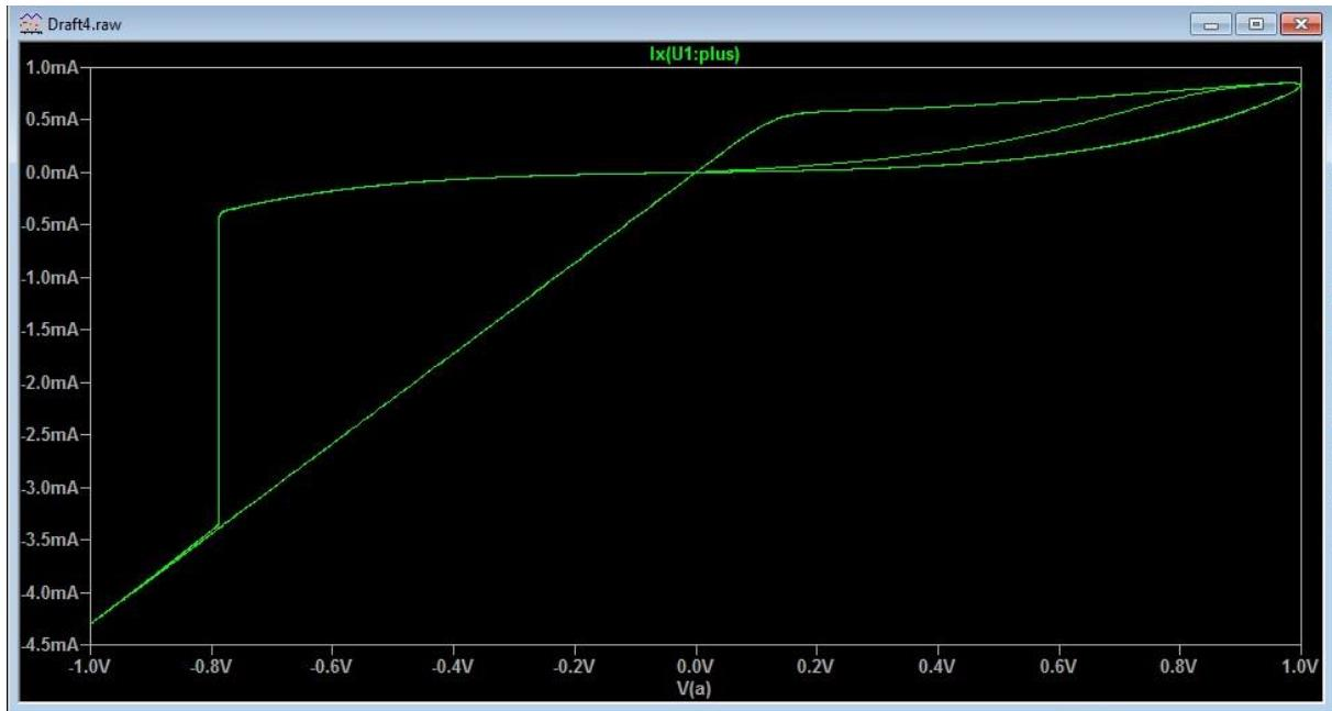
4.21. Strujno-naponska karakteristika  $\text{TiO}_2$  memristora pri frekvenciji od  $10\text{Hz}$
