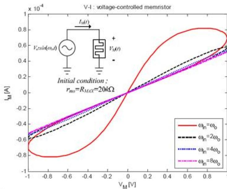
**Slika 3.2.** Strujno-naponska karakteristika naponski upravljanog memristora [10]
