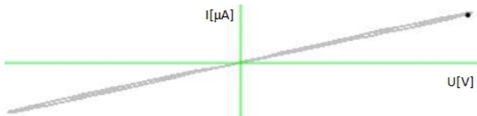
**Slika 4.7.** Strujno naponska karakteristika naponski upravljanog memristora pri frekvenciji iznosa  $40\text{Hz}$
