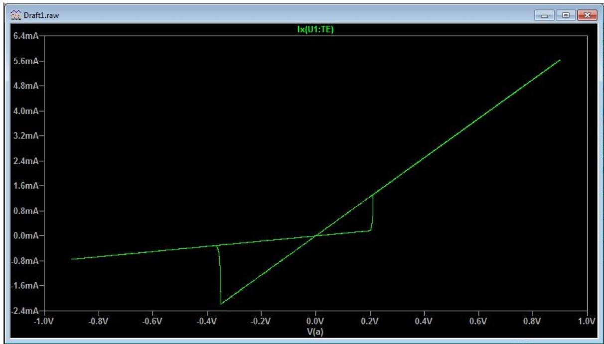
4.9. Strujno-naponska karakteristika Pino memristora pri frekveniciji od 10Hz
