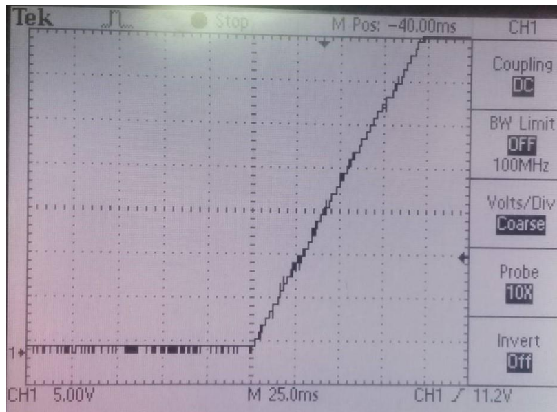
Sl. 4.4. Skokovito punjenje izlaznog kondenzatora uz ulazni napon od 18 V
