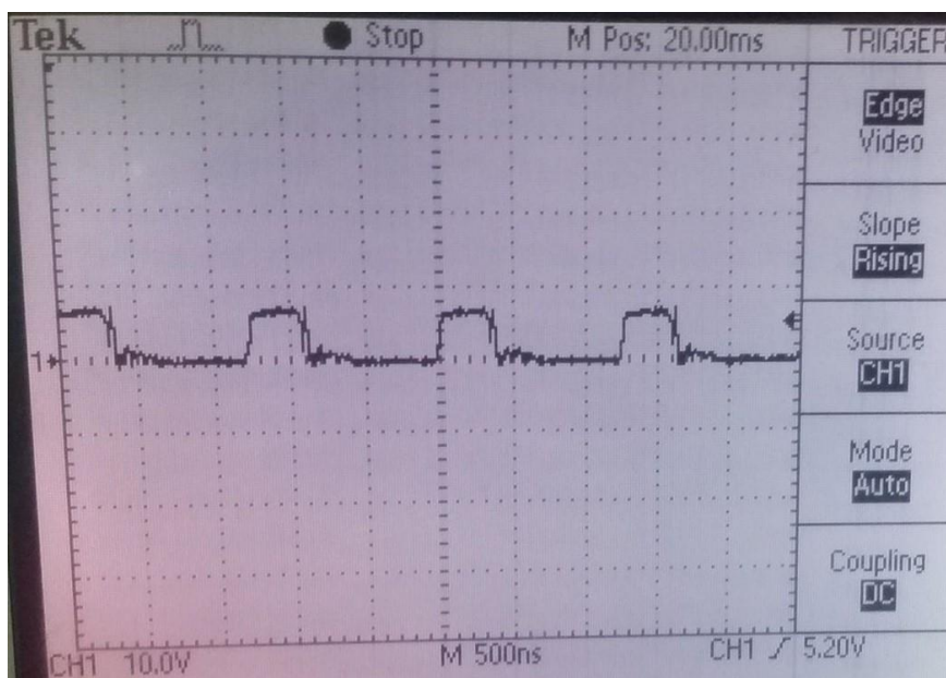
Sl. 4.10. Upravljački signal MOSFET -a pri naponu izvora od 14.7 V
