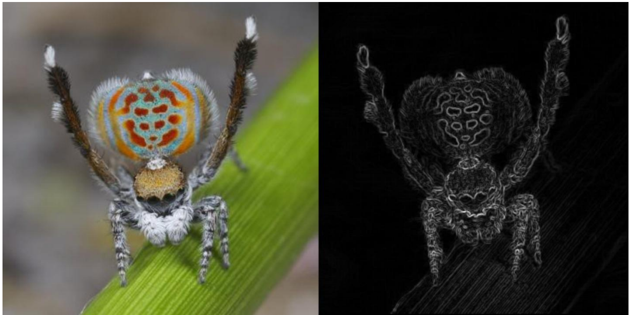
Slika 2.1. Ulaz(lijevo) i izlaz(desno) Sobel algoritma[3]
