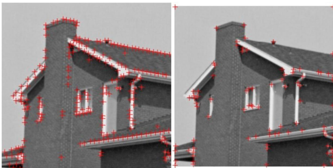
Slika 2.3. Usporedba rezultata Susan (lijevo) i Harris (desno) detektora[6]
