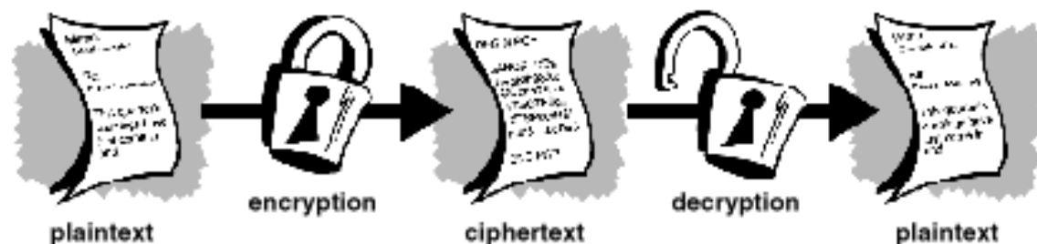
Slika 4.1. Proces prijenosa poruke pomoću kriptografije
