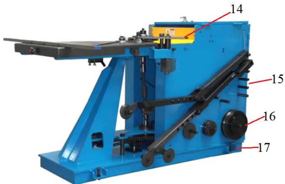
Slika 4.2b – Dijelovi stroja za izradu koljena
