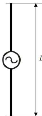
Slika 4.1. Dipol napajan u sredini
