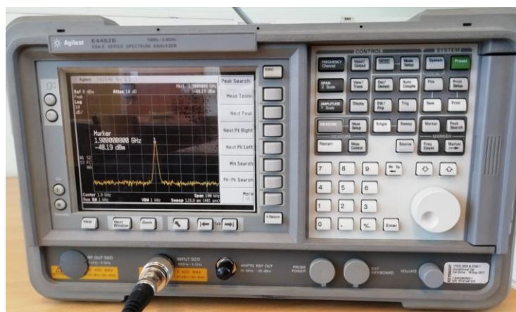
Slika 8.14. Spektralni analizator Agilent 4402B
