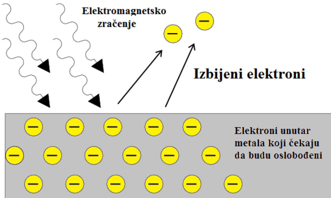
Slika 3.3.: Fotoelektrični efekt [22]
