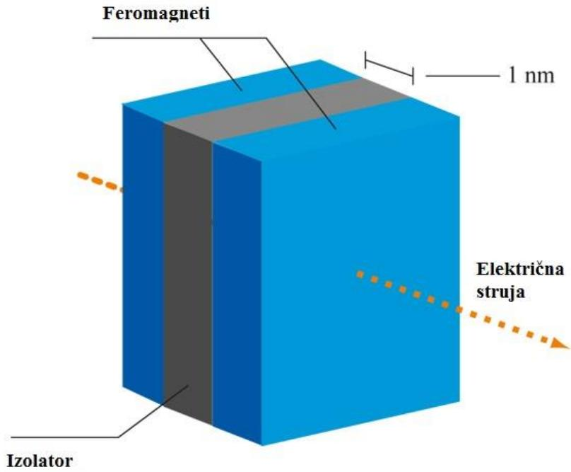
Slika 3.3.3.: Ogromni magnetootpor (GMR – *Giant magnetoresistance*) [28]
