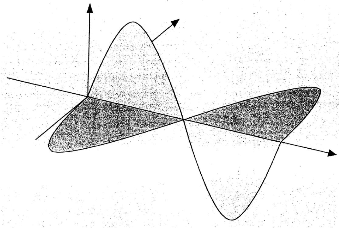
Slika 4.1.: Horizontalna i vertikalna polarizacija svjetla [1]
