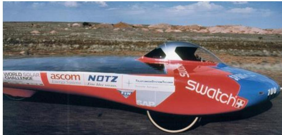
*Slika 2.4. Solarno vozilo Spirit of Biel [5]*
