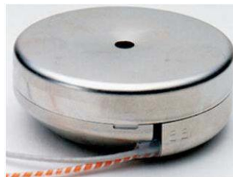
Slika 4.7. FOG žiroskop tvrtke Litton
