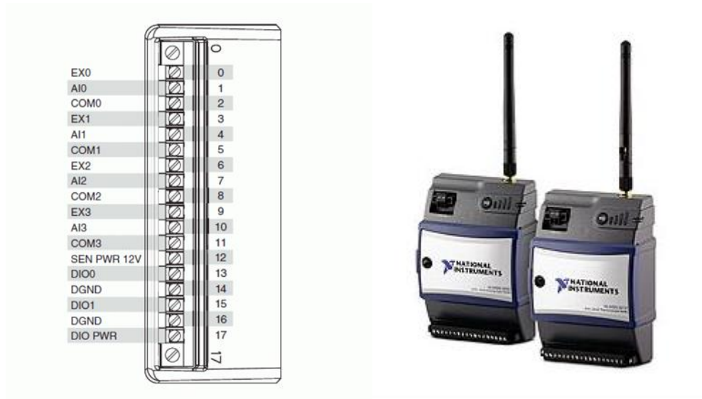
Slika 7.4. NI WSN-3202 konektorski ulazi i mjerni čvor
