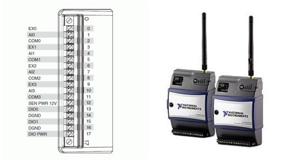
Slika 7.4. NI WSN-3202 konektorski ulazi i mjerni čvor
