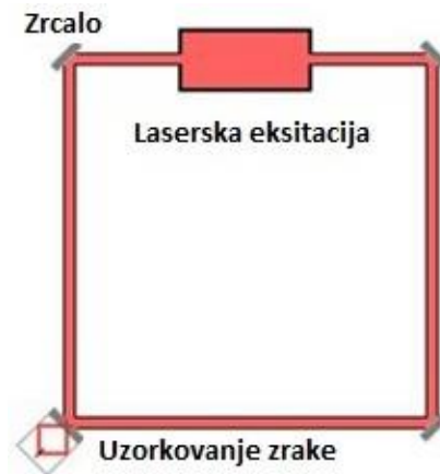
Slika 4.5. Princip rada RLG žiroskopa
