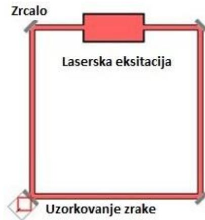
Slika 4.5. Princip rada RLG žiroskopa
