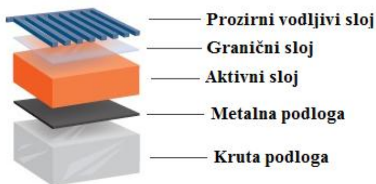
Slika 3.9. Struktura CIGS ćelije [17]
