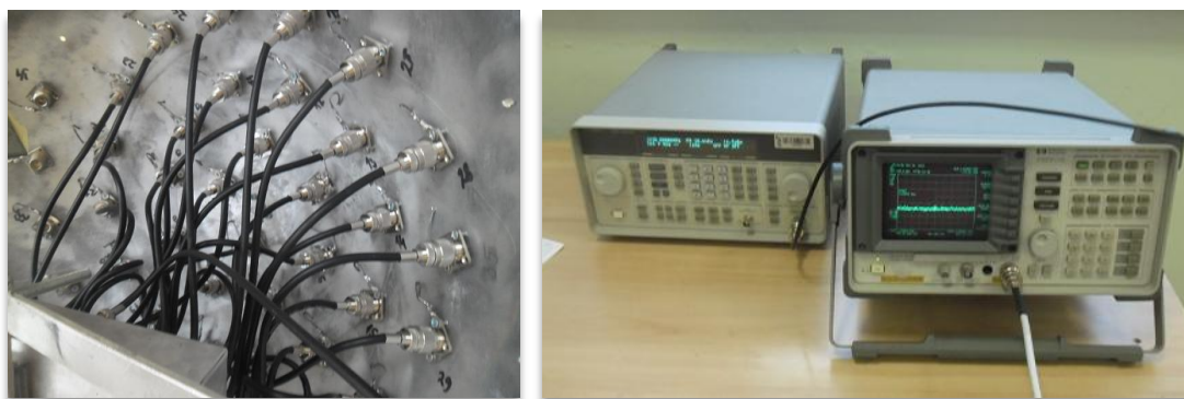
Slika 4.6. a) Spoj izlaza s djelitelja snage na 32 antenska elementa, b) generator signala i analizator spektra
