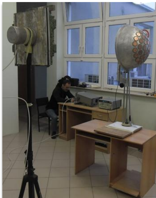
Slika 4.5. Postava za mjerenje dijagrama zračenja antenskog niza.
