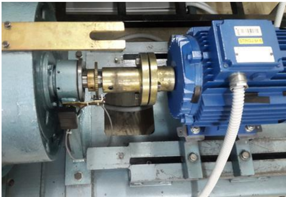
Slika 4.4. Spoj istosmjernog generatora i asinkronog motora
