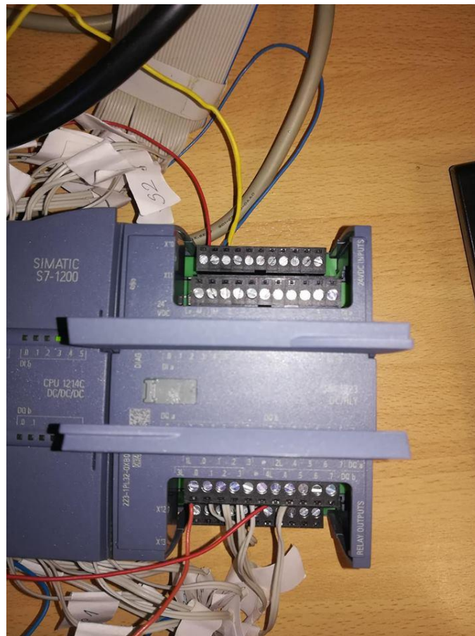
Slika 9 Dodatni signalni modul SM 1223 DI16/DQ16 x relay
