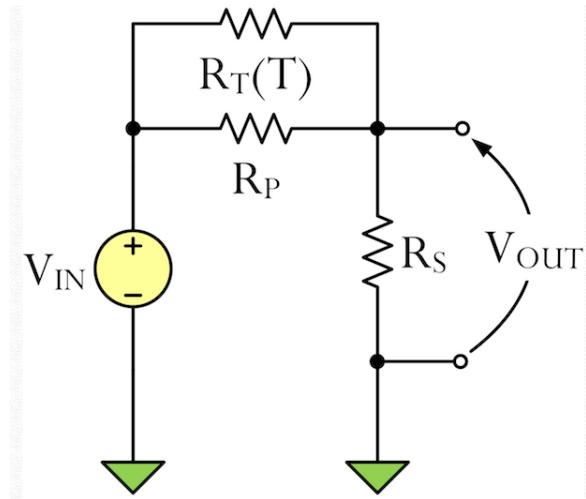
**Sl. 3.6.4.1.** linearizacija termistora spajanjem otpora u paralelu. [6]
