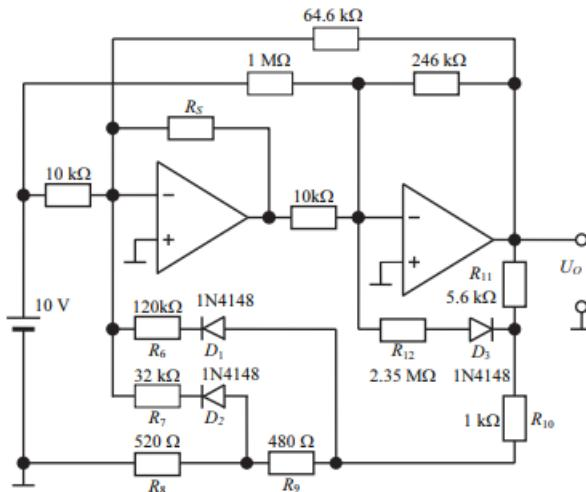
Sl. 3.6.2.1. Shematski prikaz linearizacije pomoću dioda [15]
