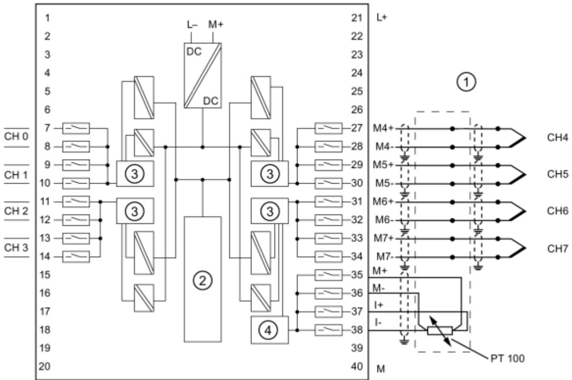
**Sl. 3.4.2.** Povezivanje termopara s PLC – om [16]
