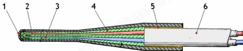
**Sl. 2.3.6.** Presjek termopara. [11]
