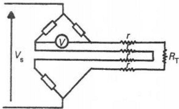
Sl. 2.1.6. Četverožičnu izvedbu RTD - a [15]
