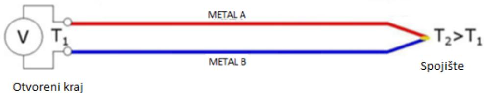
Sl. 2.3.1. Mjerjenje temperature pomoću termopara [9]
