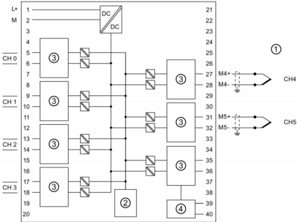
Sl. 3.4.1. Povezivanje termopara s PLC – om [16]
