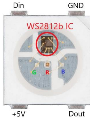
Slika 3.5. Prikaz WS2812B upravljačkog čipa.
