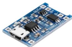
Slika 3.12. TP4056 modul za zaštitu i punjenje baterije.
