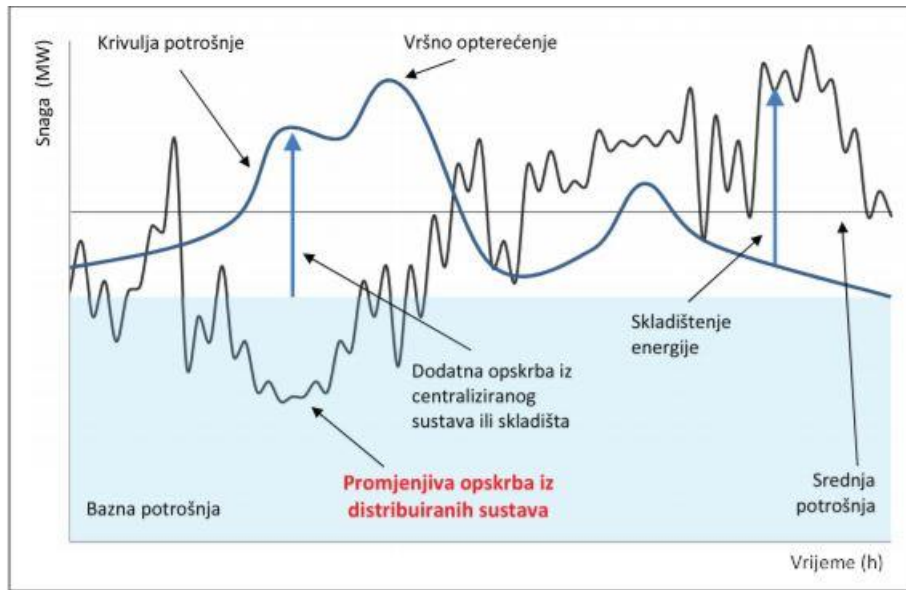
Slika 2.1. Proizvodnja, potrošnja i skladištenje energije u uvjetima korištenja distribuirane proizvodnje energije [1]
