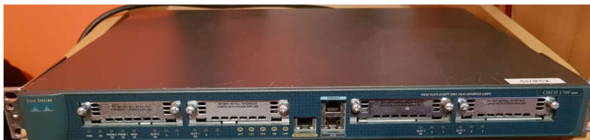
Sl. 5.9. Cisco 1760 usmjerivač
