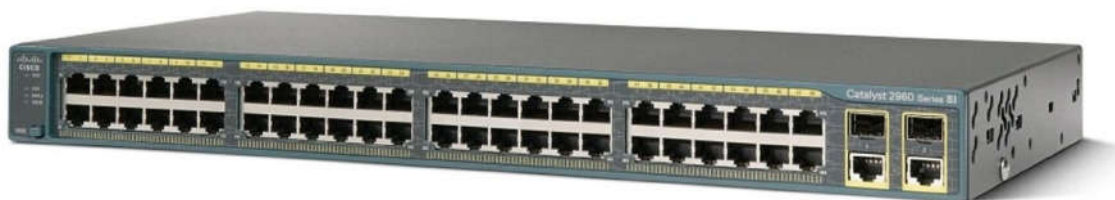
Sl. 3.2. Primjer preklopnika s 24 priključka [15]
