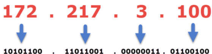
Sl. 2.3. Primjer IPv4 u decimalnom i binarnom obliku [11]
