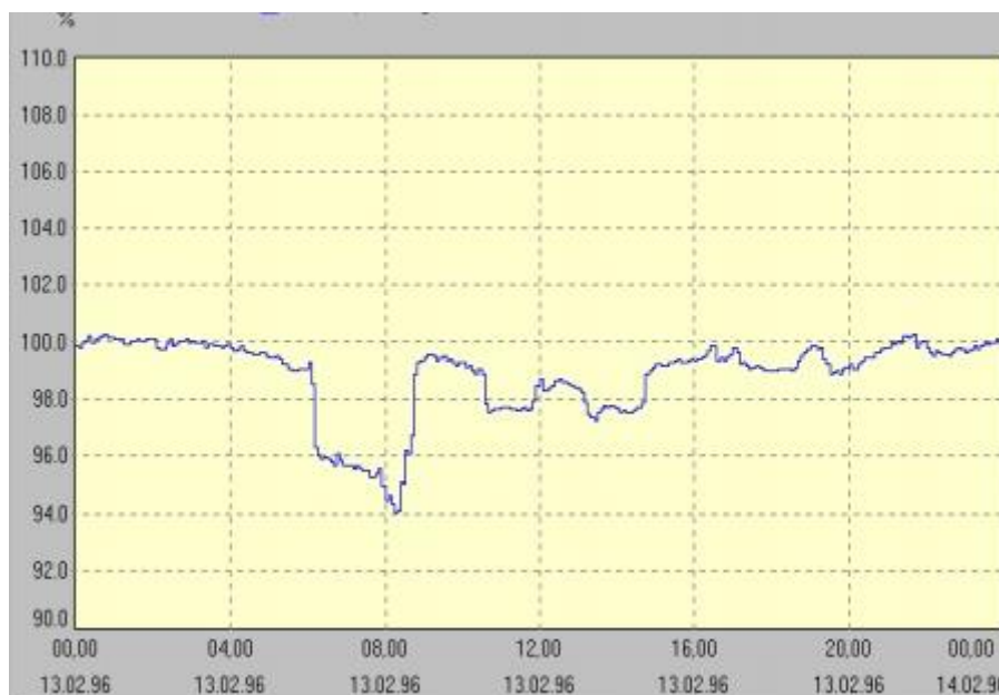
Graf 2.1. Primjer dijagram dijela desetominutnih srednjih efektivnih vrijednosti napona [3]
