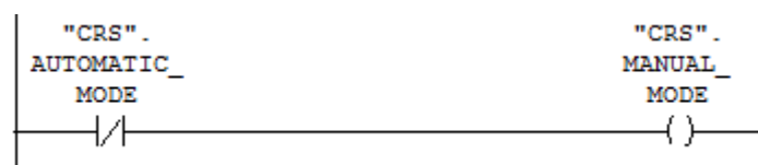
Slika 5.7 Ulazak u ručni način rada
