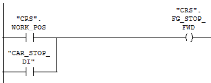
Slika 5.16 Prekid bitovne zastavice za kretanje naprijed
