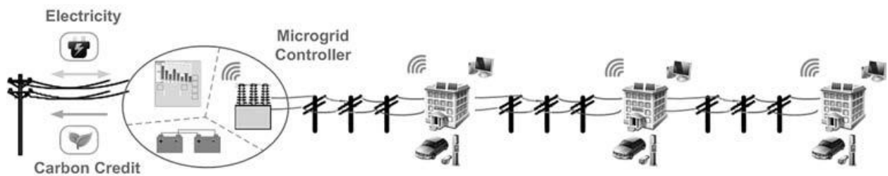
Slika 2.6. Mikromreža na distribucijskom vodu [1]
