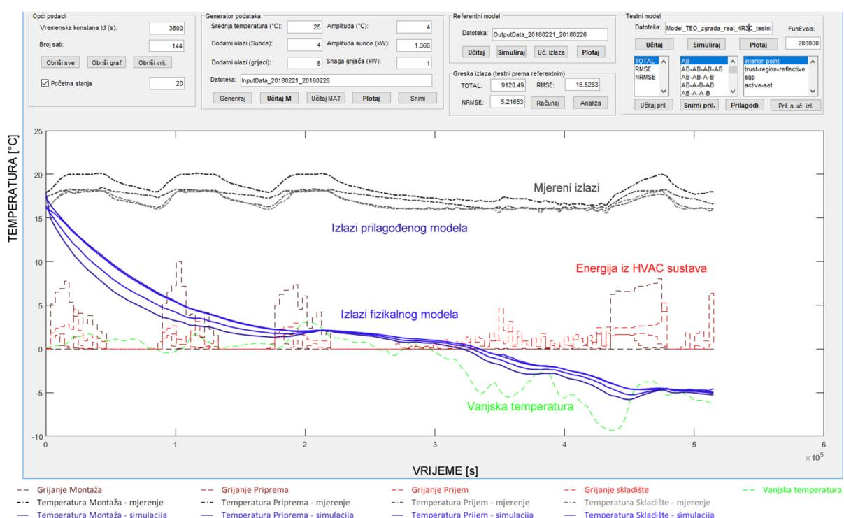
**Slika 5.1.** Usporedba rezultata mjerjenja i rezultata simulacije fizikalnog modela složenosti 4R3C
