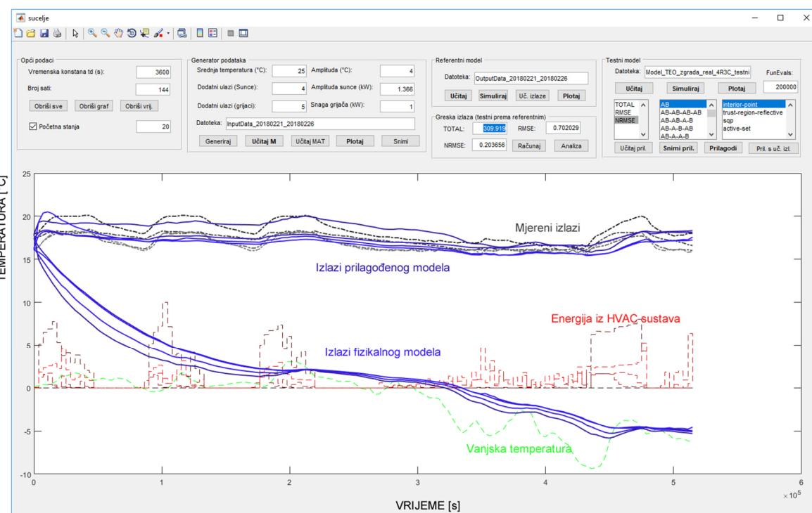
Slika 4.3. Rezultati simulacije fizikalnog i prilagođenog 4R3C modela
