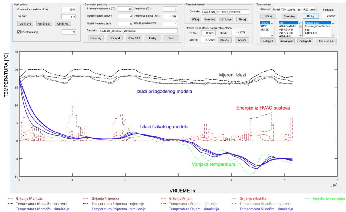
Slika 5.2. Usporedba rezultata mjerena i rezultata simulacije fizikalnog modela složenosti 3R2C
