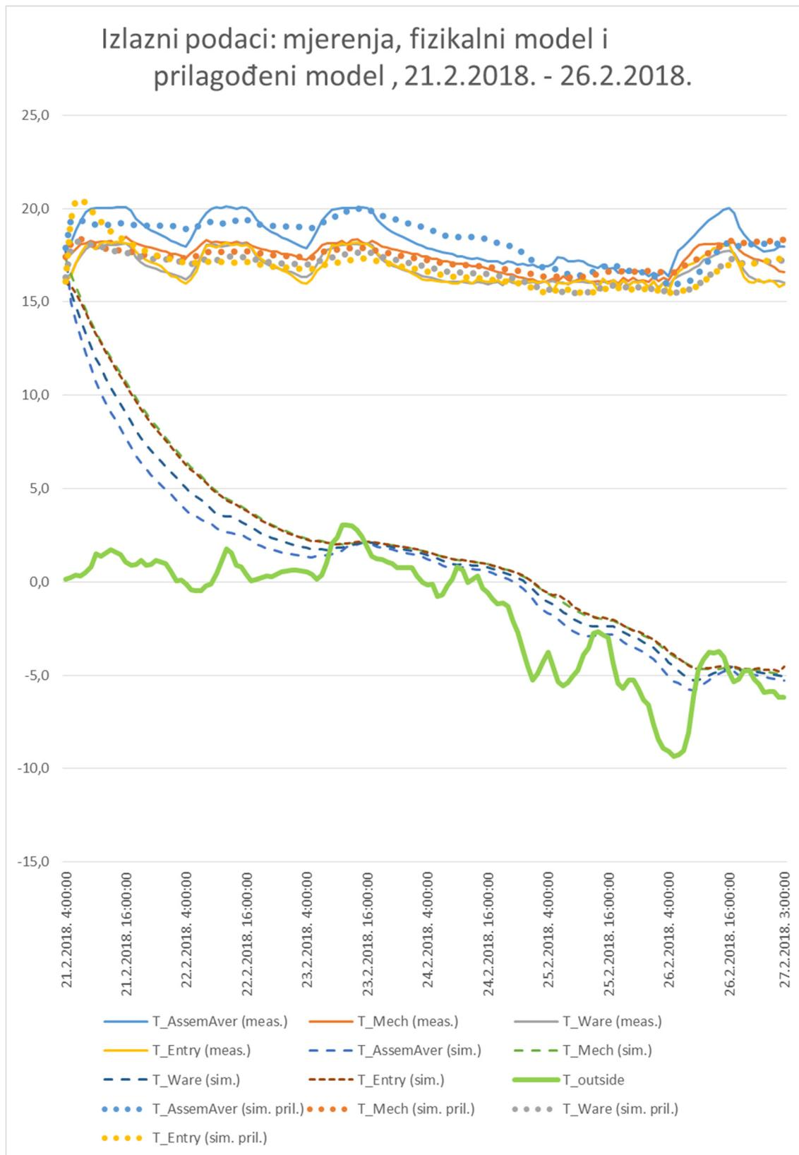
**Slika 4.4.** Usporedba izlaznih podataka: mjerjenja (puna crta), fizikalni model (crtkano) i prilagođeni model (točkano)
