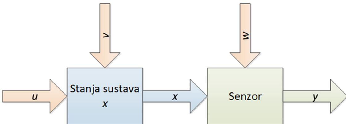
**Slika 2.4.** Jeden od prikaza sustava ( $u$  – upravljački ulazi;  $v$  – neupravljeni ulazi;  $x$  – unutarnja stanja sustava;  $w$  – nesigurnosti senzora;  $y$  – izlazi senzora, odnosno sustava) iz literature [14]
