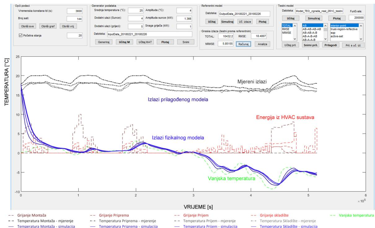
Slika 5.3. Usporedba rezultata mjerena i rezultata simulacije fizikalnog modela složenosti 2R1C
