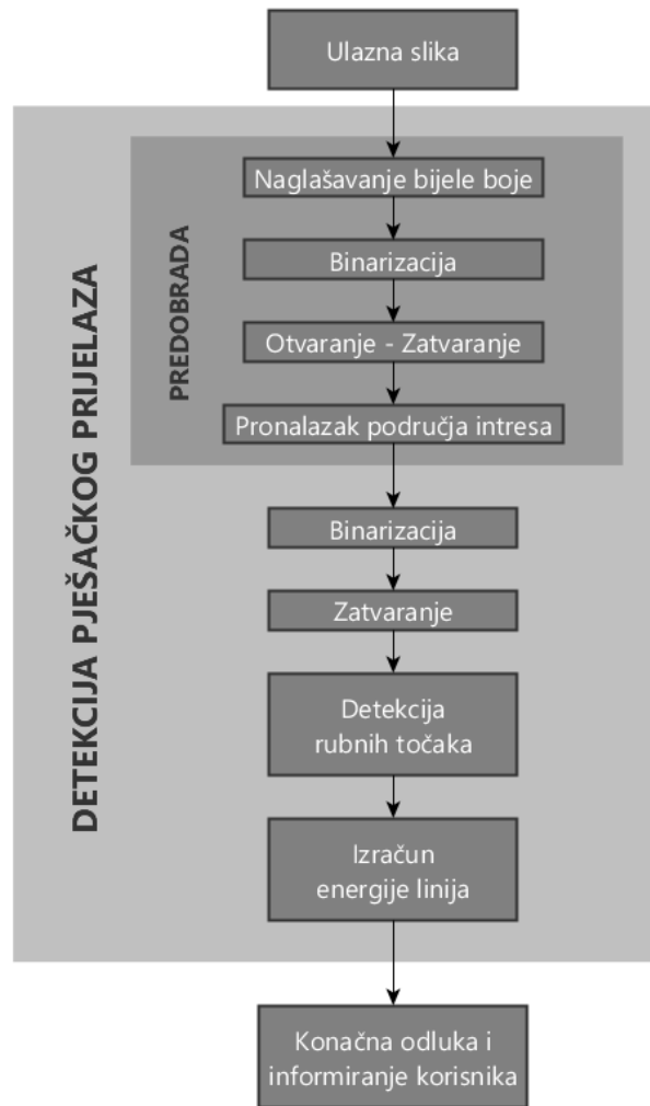
Slika 5.1. Koraci predloženog algoritma za detekciju pješačkih prijelaza
