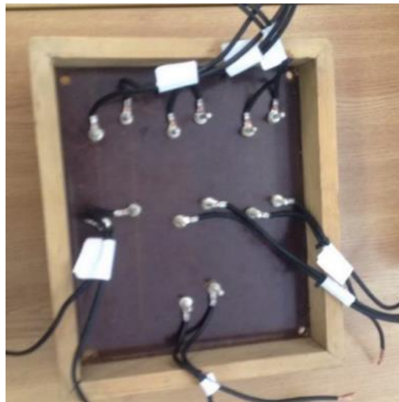
Slika 5.10. Ožičenje razvodne ploče
