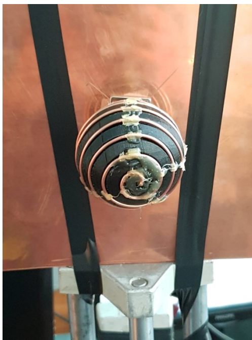
Sl.4.30. Mjerenja jakosti polja u vertikalnoj ravnini u laboratoriju za L5R (POLOŽAJ 1)
