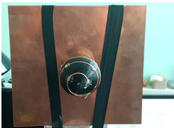
Sl.4.41. Mjerenje jakosti polja u laboratoriju u vertikalnoj ravnini za L8R (POLOŽAJ 1)
