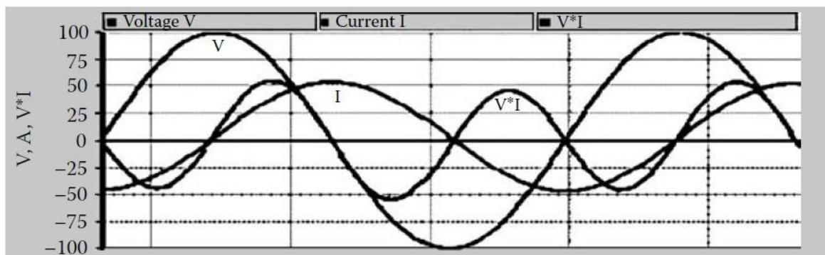
Slika 2.2. Valni oblici napona, struje i snage linearneho tereta induktivnog karaktera;[5]
