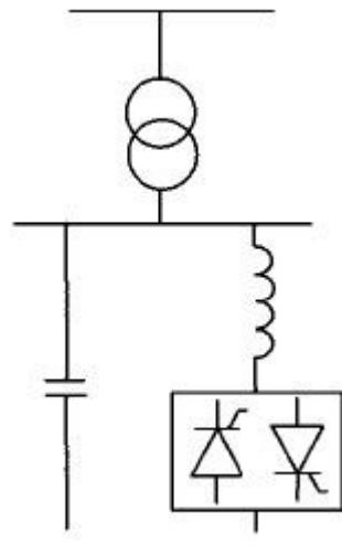
Slika 3.2. Tiristorski kontrolirana zavojnica sa filtrom;[6]
