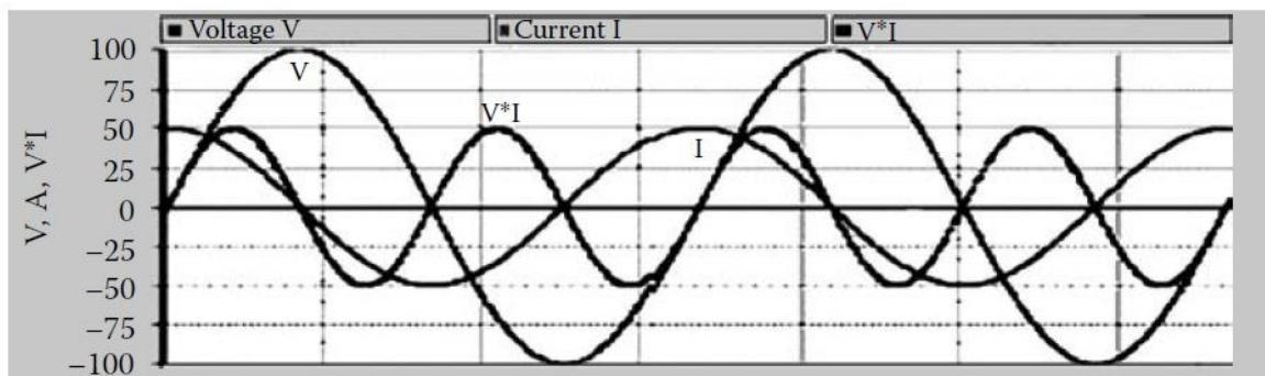
Slika 2.3. Valni oblici napona, struje i snage linearneho tereta kapacitivnog karaktera; [5]
