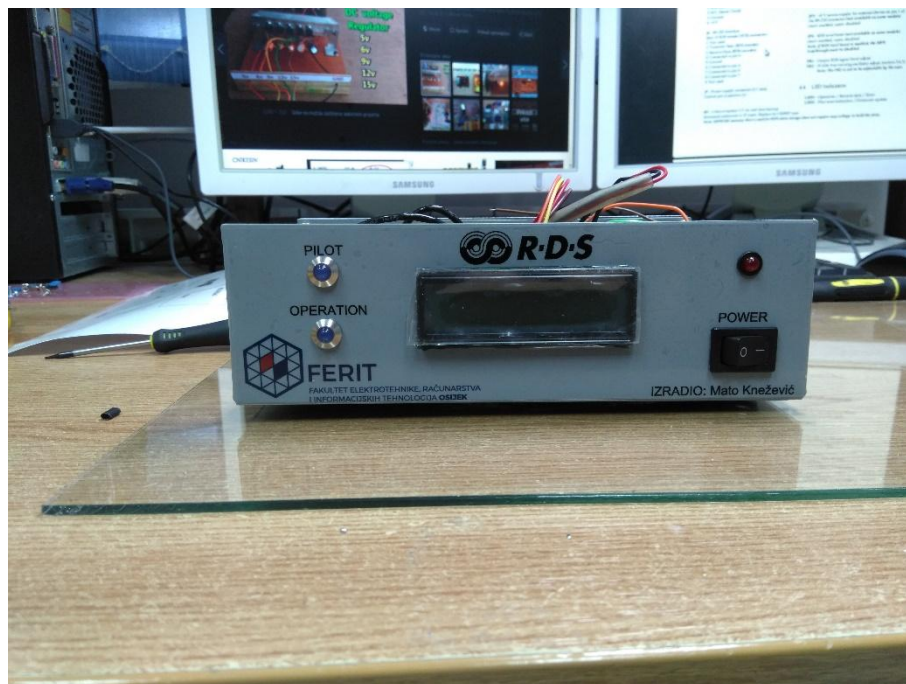
Slika 3.6. Prikaz prednje strane RDS kodera
