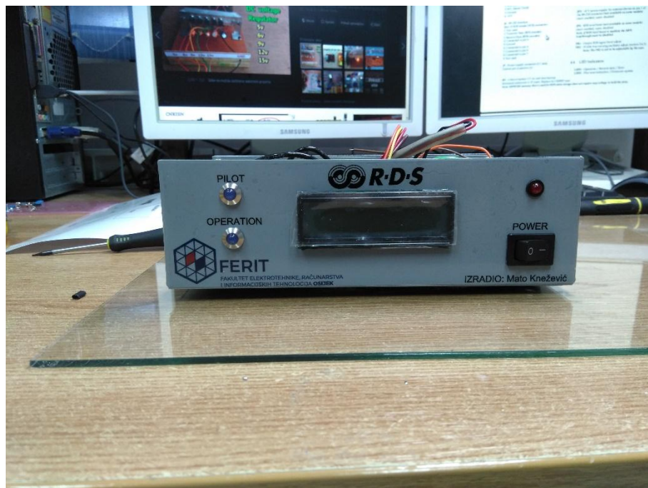
Slika 3.6. Prikaz prednje strane RDS kodera
