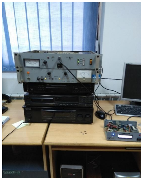
Slika 4.4. Stereo koder, exciter, RDS koder i radio prijemnik međusobno povezani prema shemi na slici 4.1.
