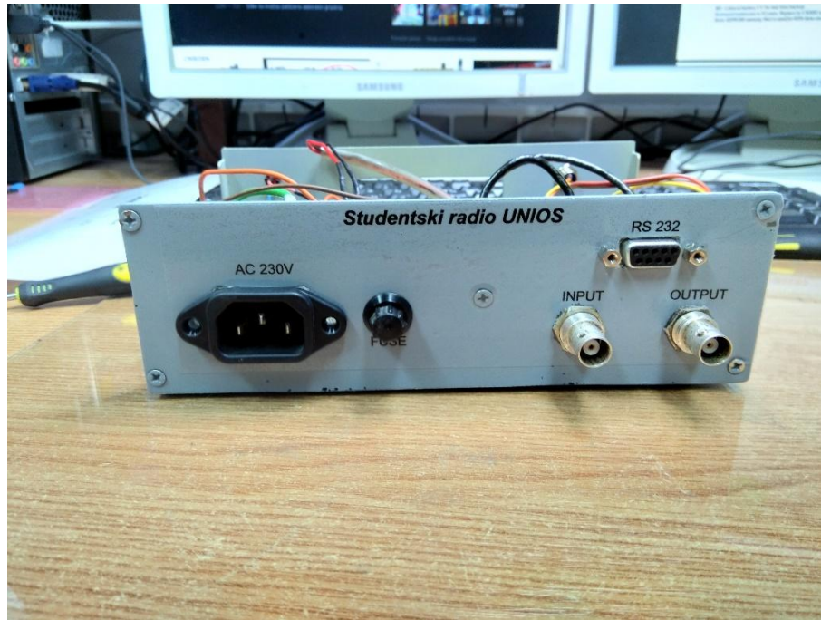
Slika 3.7. Prikaz stražnje strane RDS koder
