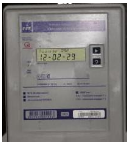
Slika 3.6. Prikaz trofaznog četverotarifnog brojila proizvođača Riz
