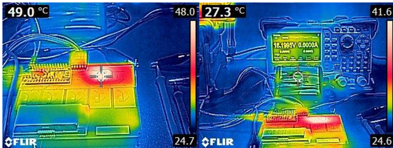
Slika 4.4. Raspodjela temperature sustava i baterije tijekom balansiranja
