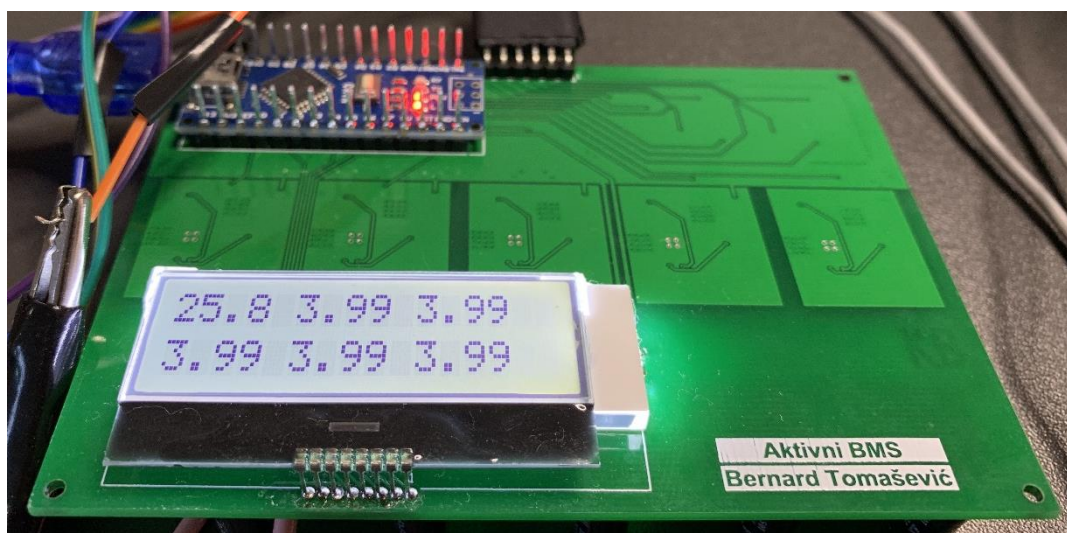
Slika 4.7. Stanje baterije na kraju balansiranja
