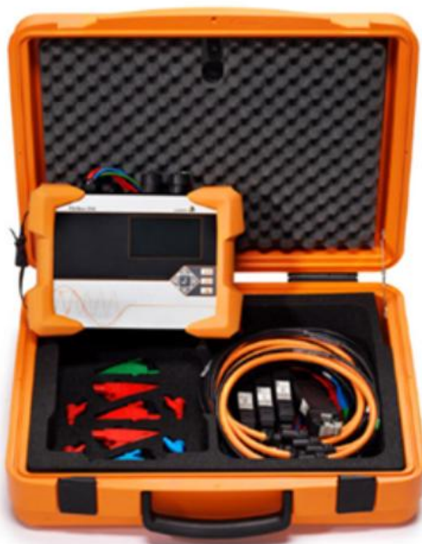
Slika 4.1. Mjerni instrument a-berle PQ – Box 200 [13]
