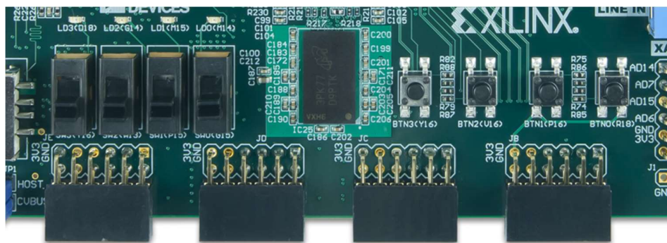
SI. 4.8. Fizički smještaj kliznih sklopki (sredina-lijevo), tipkala (sredina-desno) i LED-ica (gore-lijevo) na ZYBO pločici [13].
