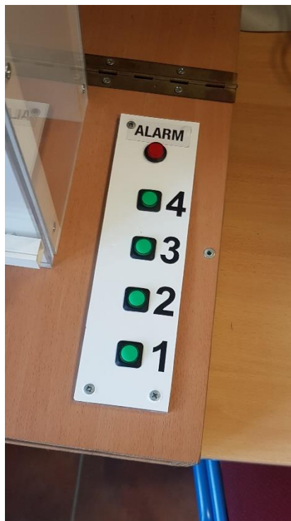
Slika 3.14. Upravljačka ploča makete dizala
