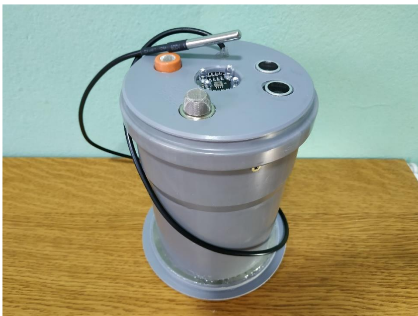
Sl. 3.21. Donja strana kućišta koja se ugrađuje unutar spremnika.
