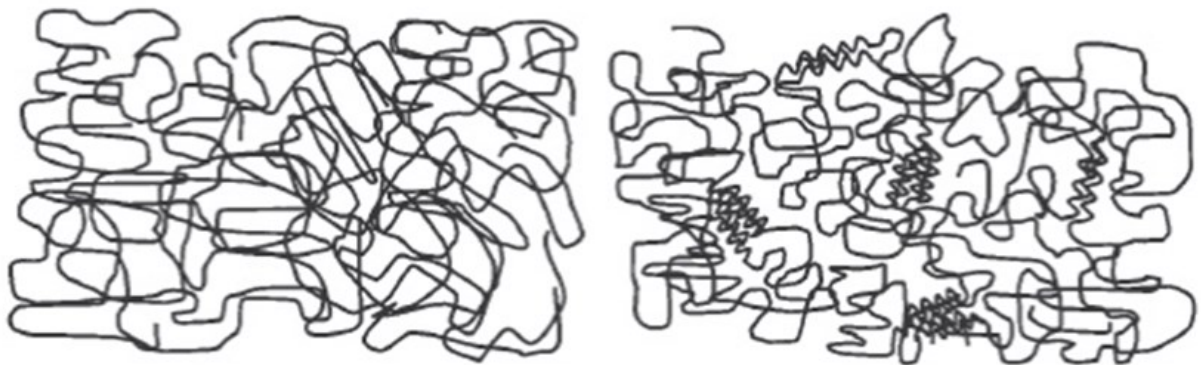
Slika 2.6 Prikaz amorfne i kristalaste strukture plastomera [11]
