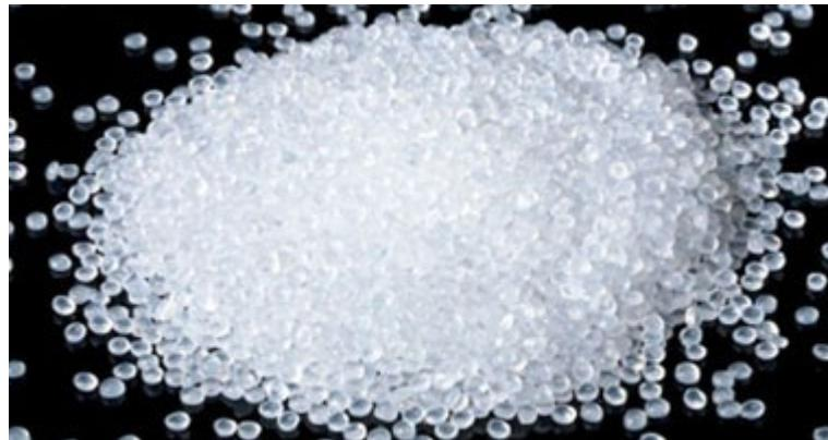
**Slika 4.4** Granulasti polipropilen [26]
