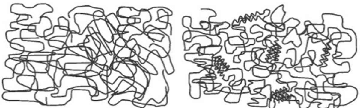
Slika 2.6 Prikaz amorfne i kristalaste strukture plastomera [11]
