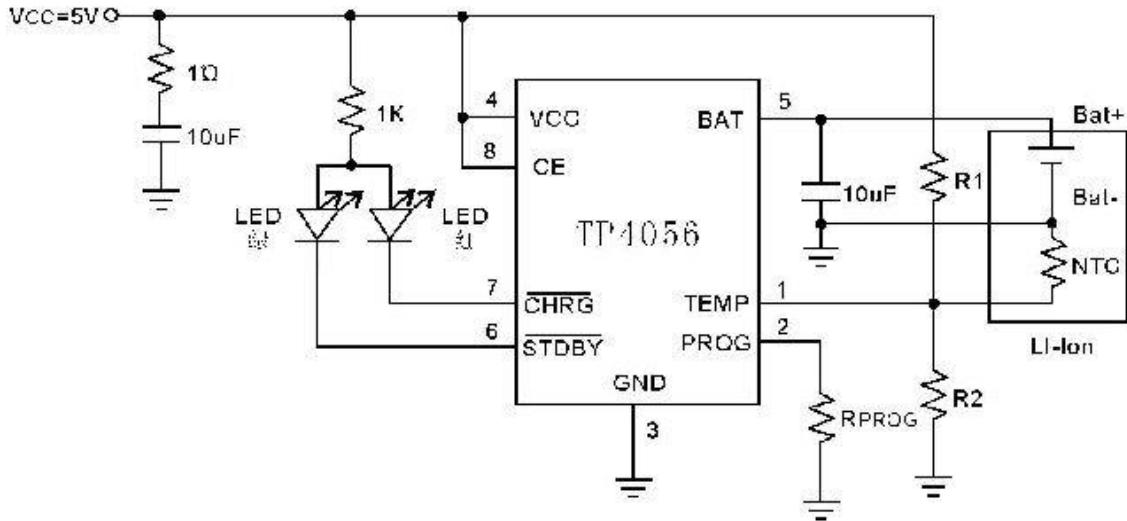
Slika 2.5. Električna shema TP4056 litij-ionskoga punjača za baterije[5].
