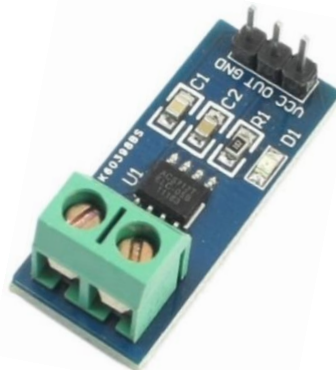
Sl.3.9. Strujni mjerni senzor ACS712T ELC-05B [7]
