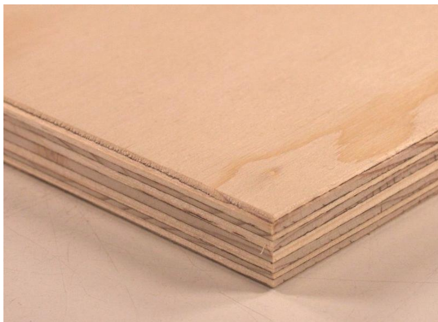
Sl. 2.8. – prikaz šperploče od 4mm koju smo koristili za izradu makete
