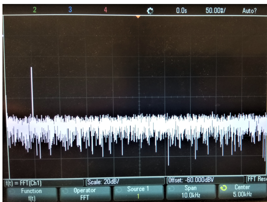
Slika 4.9. Spektar izlaznog signala za sinusoidalni ulazni signal 1 kHz i amplitudu 50 mV
