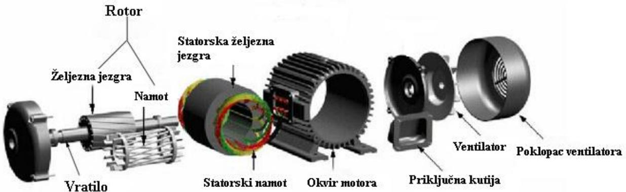
Slika 5.1 Građa asinkronog motora [8]
