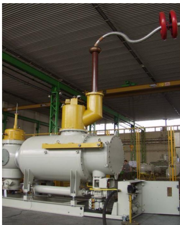
Slika 7.2 Ispitivanje funkcionalnosti visokonaponskog prekidača[1]
