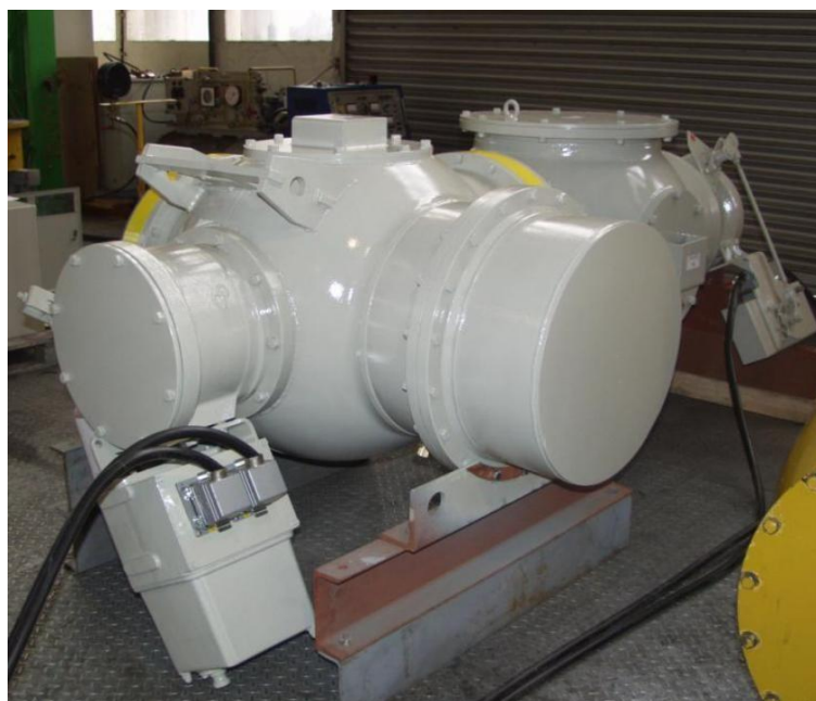
Slika 7.1 Ispitivanje funkcionalnosti rastavljača i zemljospojnika [1]
