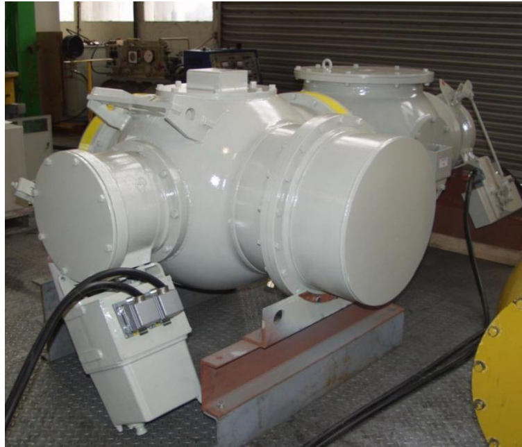
Slika 7.1 Ispitivanje funkcionalnosti rastavljača i zemljospojnika [1]
