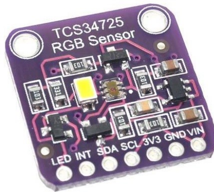
Slika 2.4. TCS34725 senzor boje. 5
