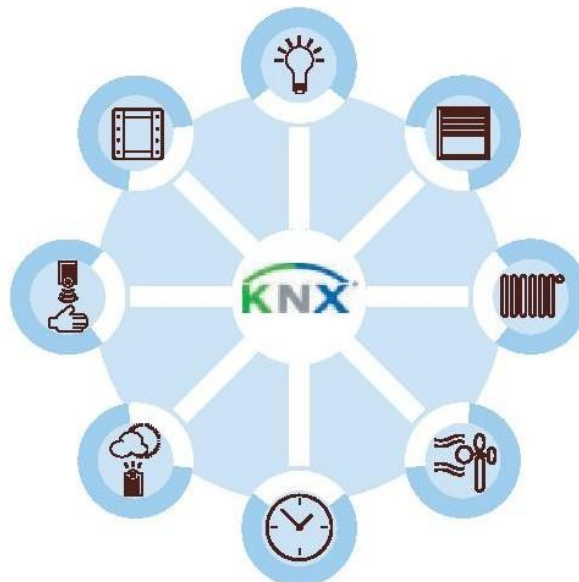
Sl.3.3. Povezanost sustava i opreme na KNX protokol [12]
