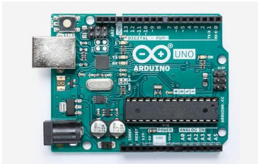
**Slika 2.1.** Arduino Uno ploča
