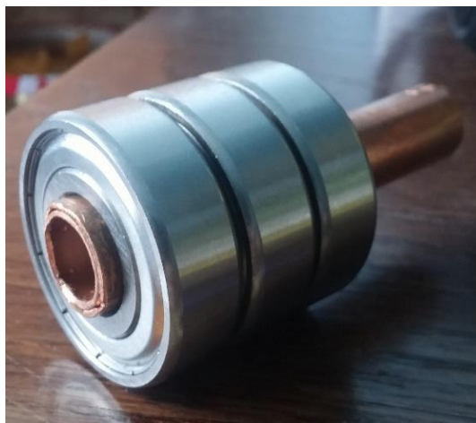
Slika 3.2. Bakrena cijev sa tri kuglična ležaja
